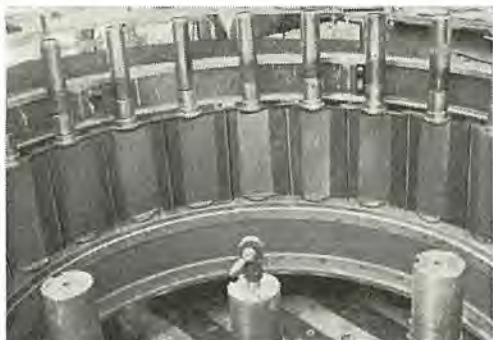
図 5.13 ガイドベーン 工場組立状況 Fig. 5.13 Factory assembling of guide vanes.
