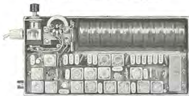
図 4.3 MT-2 送受信機内部 Fig. 4.3 MT-2 interior view.
