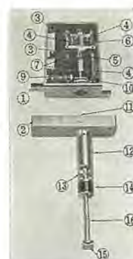
図 3.3 振動検出器構造図 Fig. 3.3 Construction of vibration detector.
