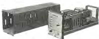
図 3.5 振動計制御箱(内部) Fig. 3.5 Control cabinet of vibrometer recorder.
