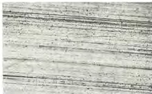
図 5.4 Nb-25% Zr 0.01 in-diam 線の顕微鏡組織 ( \times 500 )
