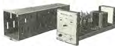
図 5.4 軸位置計制御箱 (内部) Fig. 5.4 Control cabinet of rotor position recorder.
