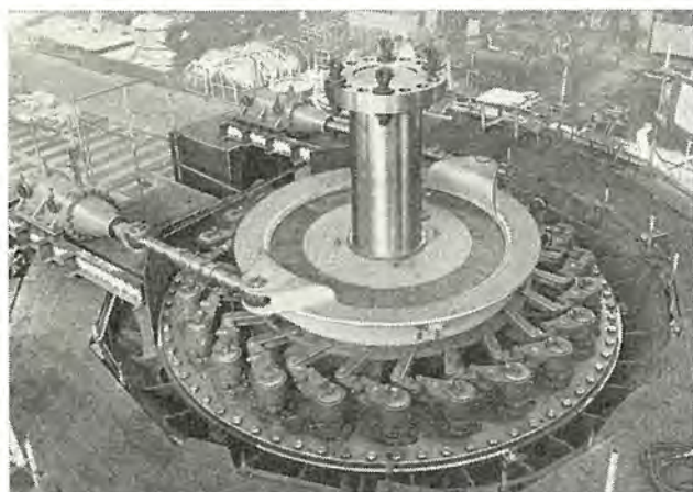
図 5.2 水車本体工場組立状況 (a) Fig. 5.2 Factory assembling of water turbine (a).
