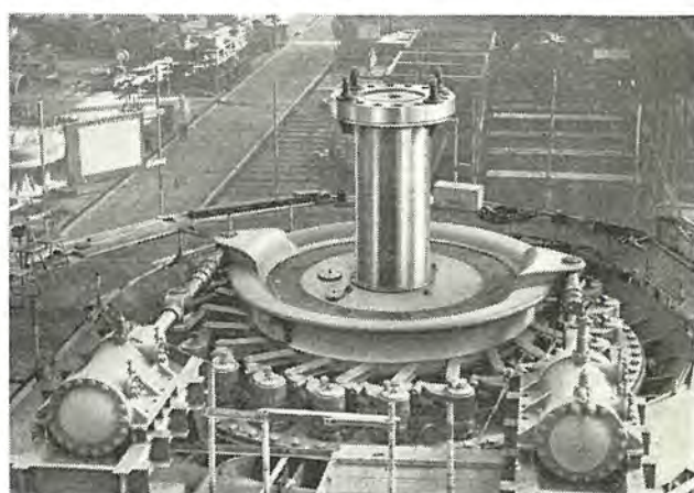
図 5.3 水車本体工場組立状況 (b) Fig. 5.3 Factory assembling of water turbine (b).
