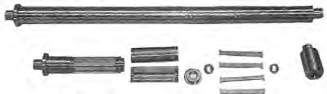
図 2.1 平板試験片およびカートリッジ Fig. 2.1 Plate type test specimens and the cartridges.
