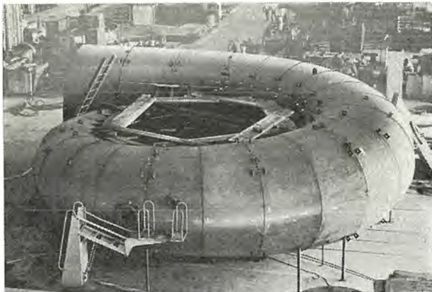
図 5.7 工場仮組立中のケーシングおよびスピードリング Fig. 5.7 Spiral casing and speed ring under assembling at the factory.
