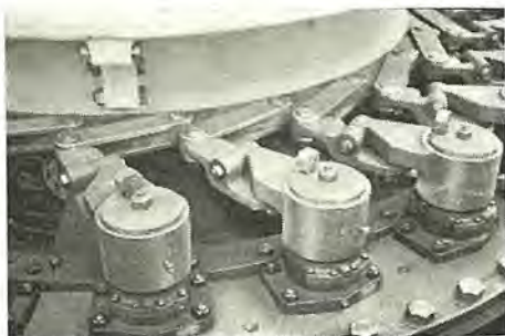
図 5.12 ガイドベーン 調整機構工場組立状況 Fig. 5.12 Factory assembling of guide vane adjusting mechanism.
