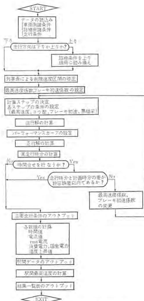
図 3.1 直流電車用ランカーブのフローチャート Fig. 3.1 Flow chart of run curve calculation for D.C. electric car.
