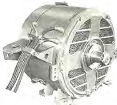
図 3.8 MB-3080-A 形主電動機外観
