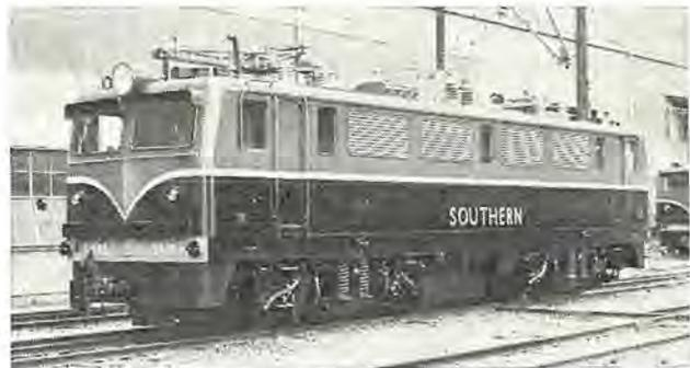
図 1.1 インド 国鉄納めメータゲージ用 52 t 交流機関車外観
