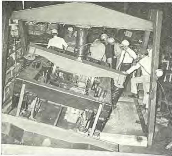
図 7.3 ボギーワックのタイプテスト (ネジリ荷重テスト)
