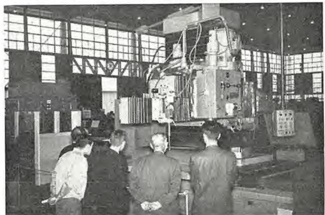
図2 ならいフライス盤制御装置
