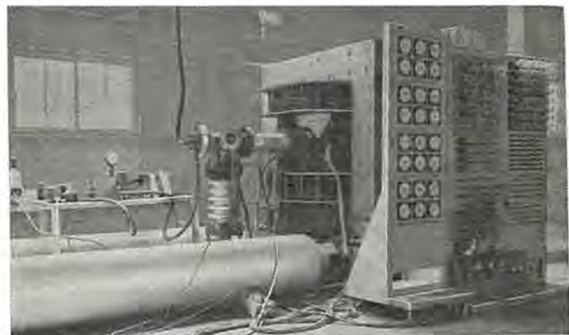
図 2.1 実験用 MHD 発電装置の外観
