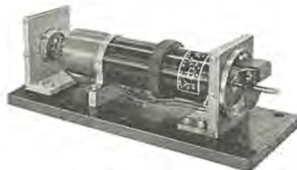
図 4.4 回転ピックアップ Fig. 4.4 Rotary pickup.
