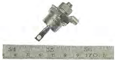
図 2.8 シリコン整流素子 Fig. 2.8 Silicon rectifier element.
