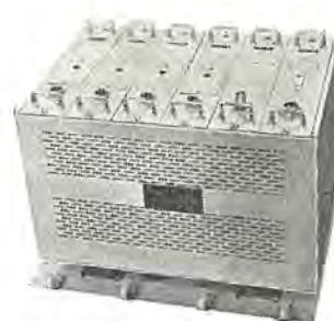
図 2 自動車用テレメータ装置 (PT-410 形) 送信機外観
