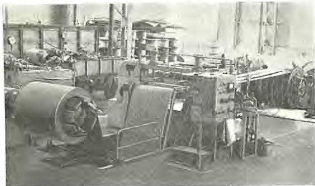
図 6.2 幅切り装置 (Gang Slitter)
