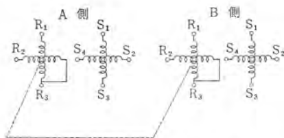
図 4.7 90 度形 ダブルレゾルバの巻線 Fig. 4.7 Winding of type 90° double-resolver.
