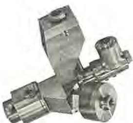
図 4.3 圧力ピックアップ Fig. 4.3 Outside view of pressure pickup.
