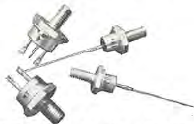
図 4.9 シリコントランジスタ パリキャップ Fig. 4.9 Silicon transistor varicap.
