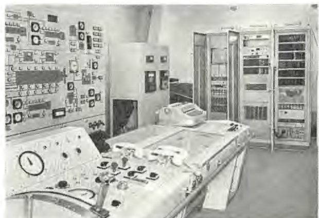
図 3.1 大阪商船納め船用データロガ設置現場 Fig. 3.1 Data logger installation for marine use.
