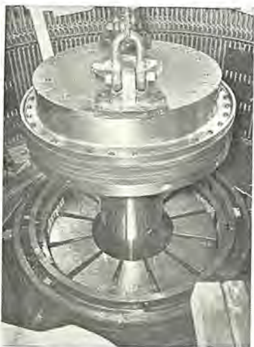
図 2.8 ス ラ ス ト 軸 受 Fig. 2.8 Thrust bearing.
