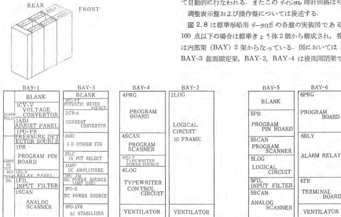
図 2.8 標準形船用データロガの実装図 Fig. 2.8 Marine data logger module assembly.
