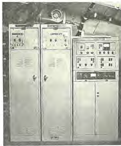
図 5.1 機器装備 (左から送信, 受信, 端局架) Fig. 5.1 Allocation of transmitter, receiver and multiplex terminal.
