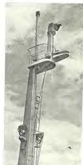
図 3.3 船首マストに取り付けたカメラ部 Fig. 3.3 TV camera installed on the mast of the bow.
