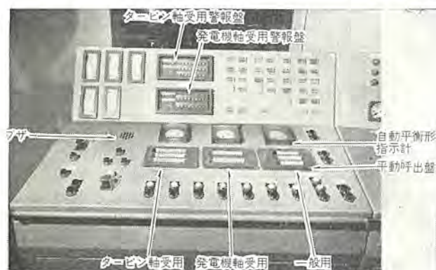
図 3.5 制御盤の一部 (Mos King 号) Fig. 3.5 Part of control panel.
