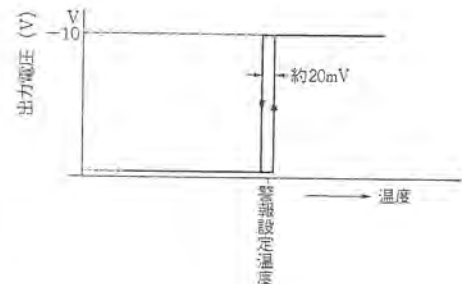
図 4.5 シュミットトリガ特性 Fig. 4.5 Schmitt trigger characteristics.
