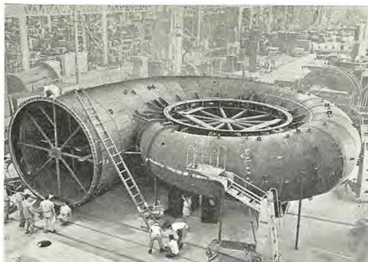
図 5.4 工場組立中の ケーシング および スピードリング Fig. 5.4 Spiral case and speed ring under machining at the shop.
