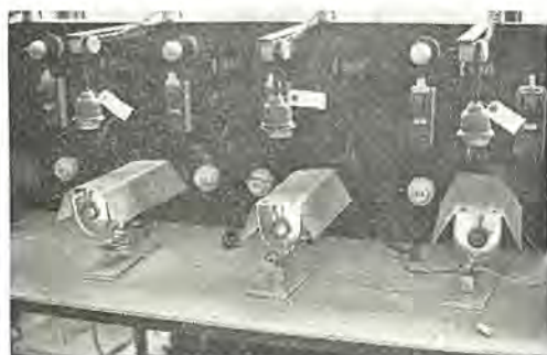
図 2.3 接点寿命試験装置 Fig. 2.3 Life test device of thermostat.
