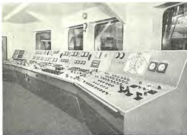
図 3.1 S.S. MOSKING の中央制御室に設けられた コントロールコンソール Fig. 3.1 Control console installed in the central control room of S.S. MOSKING.
