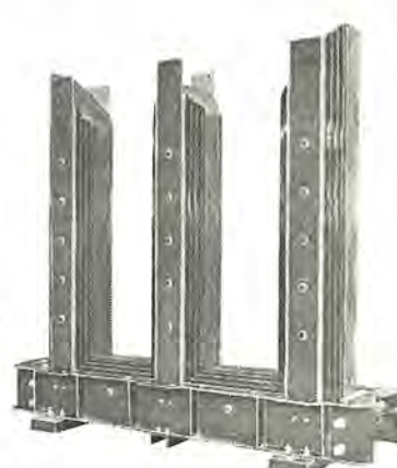
図 5.5 内鉄形鉄心 (15 MVA, 3φ)
