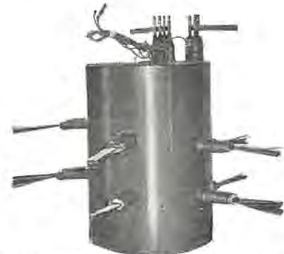
図 2.17 粉末モールド磁性材料を用いた試作高周波変圧器 (535 kVA, 800 V, 1φ 水冷式)
