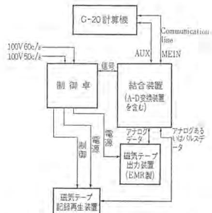
図 2.2 データ処理部ブロック線図 (計算機室内)
