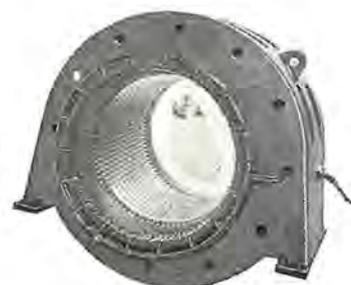
が不可能でコイルは型巻のダイヤモンドコイルとしている。したがってコイルを半閉スロットに入れるため、1スロットあたり4コイル辺を納めるようにし、その1コイル辺は半閉スロットの開口部を通過してそう入できるものとした。つまり1スロットあたり2コイルを納めている。図5.1参照、図5.2は完成固定子である。
