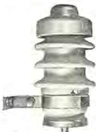
図1 LV-GL形定格8.4kV 避雷器(S形支持金具付、リード線はドライブで簡単に接続できる。また線路側の磁器フタは着脱自在である)
