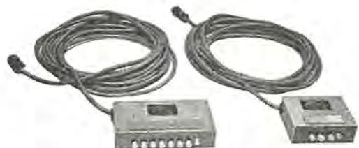
図 3.3 状態コード発生装置（左：3 bit 用、右：2 bit 用）
