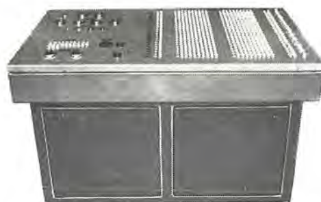
図 2.8 ロール 圧下自動制御用 プロダック 操作盤 Fig. 2.8 "PRODAC" control desk for automatic screw down control.
