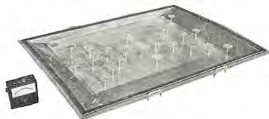
図 7.9 列車用 400 Mc 帯指向性埋込み形アンテナ (カバーを取りはずしたところ) Fig. 7.9 Flush-mounted directional antenna for 400 Mc-band radiotelephones for trains—its cover is removed.
