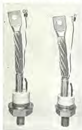
図 9.8 大容量シリコン制御整流素子—トリニスタ CR-350形(左)、CR-250形(右) Fig. 9.8 High power silicon controlled rectifiers—"Trinistors"
