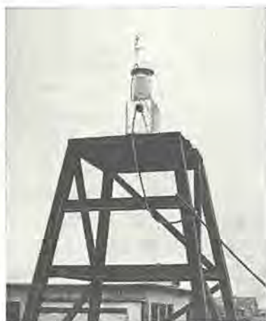
図 10.21 木製の台の上におかれた磁力計ヘッド（アラスカ探検隊用） Fig. 10.21 Magnetometer head.
