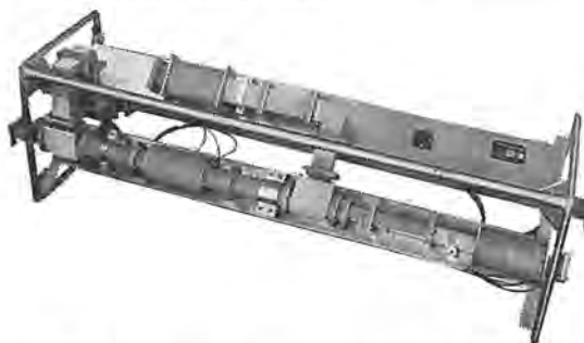
図 7.16 5 Gc 反射形フェライト無限移相器 Fig. 7.16 Reflection type infinitely variable ferrite phase shifter.
