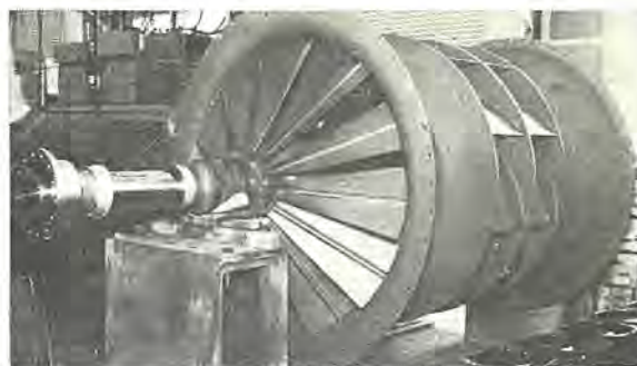
図 2.77 押込送風機の車輪
