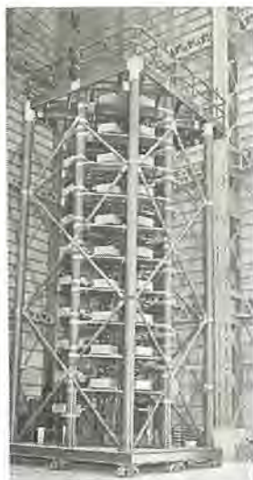
図 1.39 衝撃電圧発生装置 Fig. 1.39 Outline of impulse generator.
