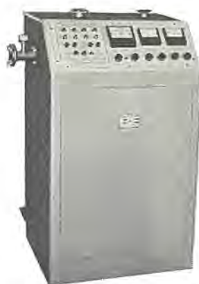
図 10.20 真空漏エィ検出器 MS-803 S 形 Fig. 10.20 Vacuum leak detector.
