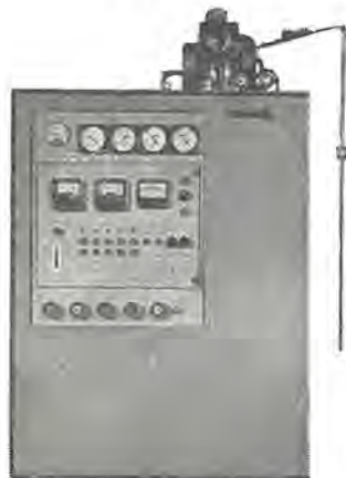
図 14.3 UL-80 形ヘリウム 液化装置本体 Fig. 14.3 Helium cryostat.
