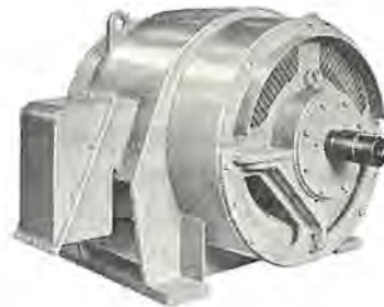
図 3.6 開放防滴 220kW MKB 5068 6,000 V 50 c/s 6 P 1,000 rpm Fig. 3.6 MKB 220 kW open dripproof motor.
