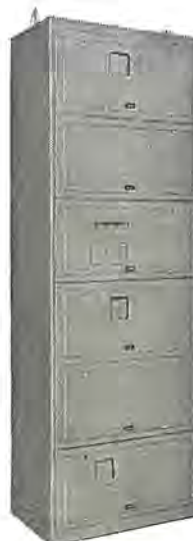
図 3.4 TS-1 形 ATC 制御装置 Fig. 3.4 Type TS-1 ATC apparatus.
