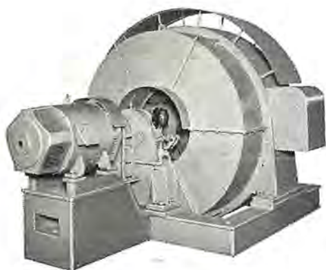
図 3.14 ソ連向け フードボードプラントデスクリファイナー 駆動用 450 kW 同期電動機
