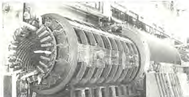
図 1.1 396 MVA 3,600 rpm 内部冷却タービン発電機
