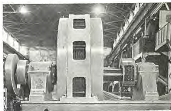
図 3.13 台湾 アジアセメント 向け 750 kW (ボールミル 駆動用) 電磁クラッチ 同期電動機
