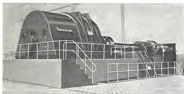
図 3.2 仕上圧延用 2-3,500 HP 直流電動機
