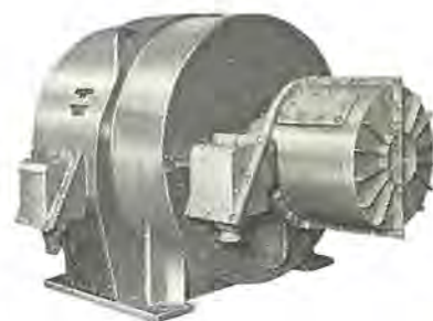
図 2.31 MSB-X 形安全増防爆形誘導電動機 400 kW, 3,300 V 60 c/s 10 P 720 rpm Fig. 2.31 Increased safety type MSB-X induction motor.
