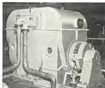
図 4.5 Hemisphere Shipping 社向け自励タービン発電機（全閉空気冷却器付） 1,100 kVA 450 V 2 P 3,600 rpm
