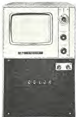
図 12.2 三菱トリネスコウ方式カラーテレビ 受像機 6CT 333 形
