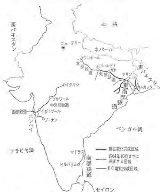
図 2.3 インド 国鉄の単相 50 c/s, 25 kV 交流電化図
