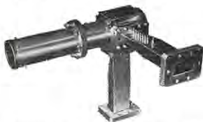
図 7.13 移相器およびフィードホーンを接続した6 Gc 帯円形導波管ハイブリッド回路 Fig. 7.13 6 Gc-band circular waveguide hybrid junction with phase shifter and feed horn.
