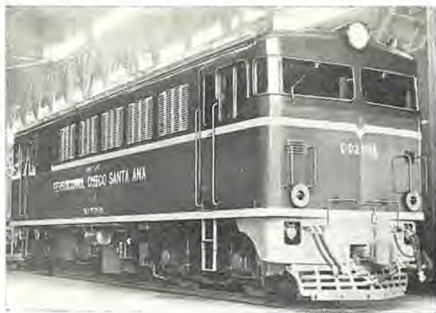
図 2.4 ペルー 国鉄向け DD260 形電気式ディーゼル機関車
