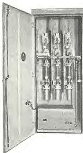
図 1.20 LCB-BA-400C 形 電力ヒューズ 付負荷断路器 屋外用, 箱入 電動操作式 6,900 V 400 A 300 MVA
