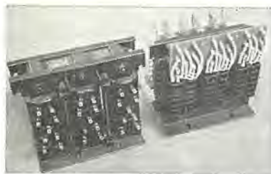
図 4.9 リアクトル変流器 Fig. 4.9 Reactor and current transformer.
