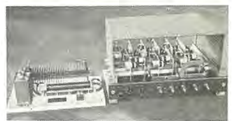
図 4.11 シリコン整流器とサージ吸収装置 Fig. 4.11 Silicon rectifier and surge absorber.
