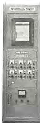
図 10.28 ND-6302 形 中性子線 エリアモニタ Fig. 10.28 Type ND-6302 neutron area monitor.
