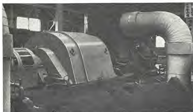
図 2.19 三相誘導電動機 5,800 kW 11,000 V 60 c/s 2 P 3,600 rpm Fig. 2.19 Three phase induction motor.
