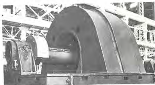
図 2.18 八幡製鉄(堺) 熱間連続圧延設備粗圧延機 駆動用同期電動機
