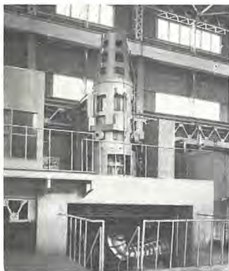
図 2.12 750 kW 直流動力計 Fig. 2.12 DC dynamometer.
