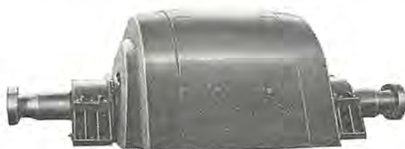
図 1.4 62,000/54,000 kVA 514 rpm 水車発電機 Fig. 1.4 Water wheel generator.
