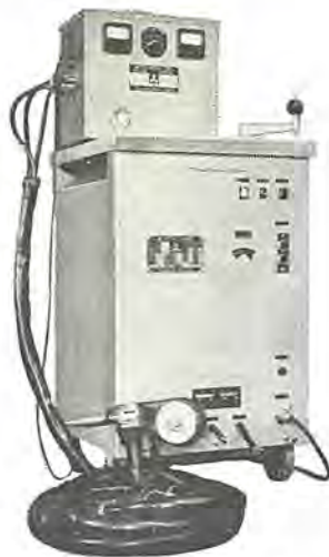
図 2.71 “三菱 アーク” SA-100 形半自動溶接装置 Fig. 2.71 “Mitsubishi arc” type SA-100 semi-automatic arc welding equipment.
