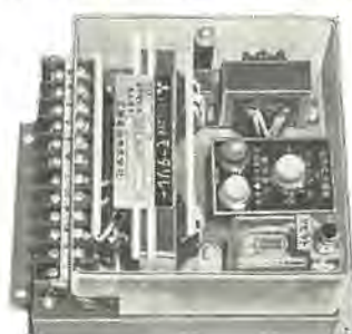
図 2.23 モータリレー Fig. 2.23 Motor protective relay.
