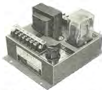
図 2.28 交流タイマ（盤内取付形） Fig. 2.28 AC timer.
