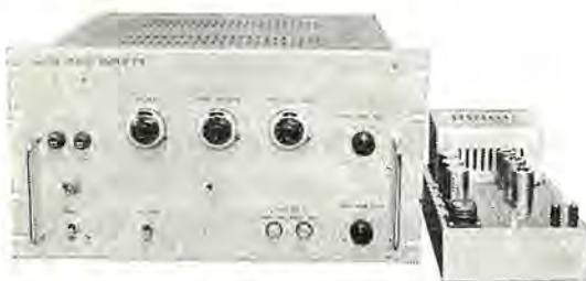
図 6.2 低雑音電荷増幅器 Fig. 6.2 Low noise charge sensitive amplifier.
