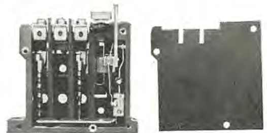
図 7.2 (b) TR 形熱動過電流継電器の内部 Fig. 7.2 (b) Interior of type TR thermal over current relay.
