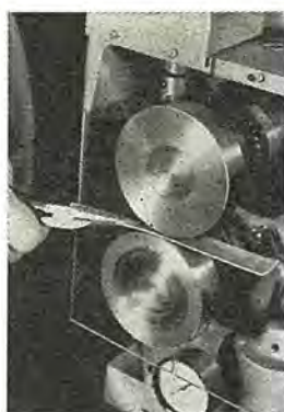
図 10.2 アルミ板のシーム溶接 Fig. 10.2 Ultrasonic seam welder for aluminum strips.
