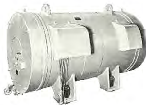
図 2.1 25 kVA 20,000 c/s 高周波発電機
