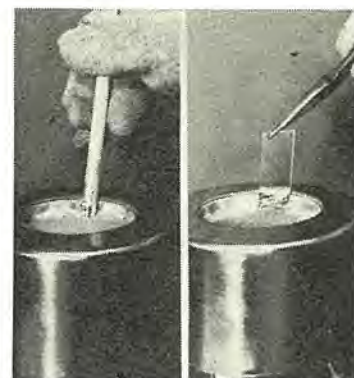
図 10.3 アルミ棒やガラスのスズメッキ Fig. 10.3 Ultrasonic tinning of aluminum, ceramics, and glass.
