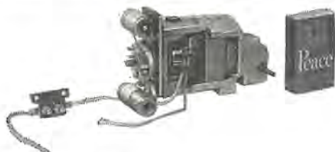
図 4.11 FB-NG 形シリーズモトル（ガバナ付） Fig. 4.11 Type FB-NG series motor (attached speed governor).
