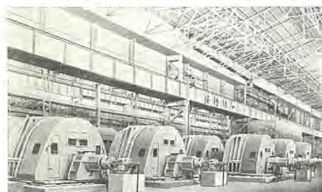
図 5.3 高速熱間仕上圧延用 ミルモータ 群 Fig. 5.3 Main drive DC motors for high speed hot strip mill.
