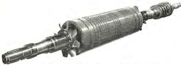
図 3.4 マルティプルラディアル 通風方式の回転子 Fig. 3.4 Rotor of multiple radial ventilation system.
