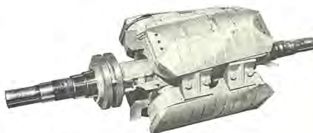
図 2.6 突極形ダンパレス同期電動機回転子 Fig. 2.6 Rotor of salient pole type damperless synchronous motor.
