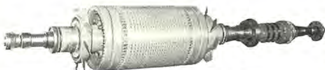
図 5.4 バインド線を巻いた回転子 Fig. 5.4 Rotor bound with binding wire.
