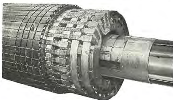
図 5.6 リテーニングリング 取付前の回転子 コイルエンド Fig. 5.6 Rotor coil ends before the retaining ring is attached.
