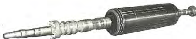
図 5.7 リテーニングリングを取り付けた回転子 Fig. 5.7 Rotor with retaining rings attached.
