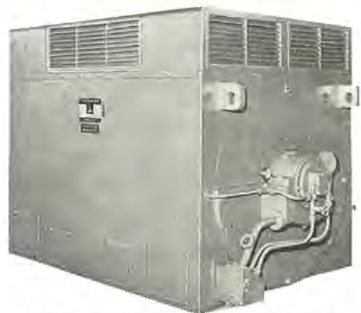
図 9.4 防滴保護形 (サイレンサ付) カゴ形電動機 3,000kW 4P 3,300 V 60 c/s
