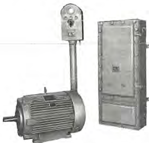
図 4.2 XF 形水素 ガス 耐圧防爆形電動機と管制器 25 kW 6 P 200 V 50 c/s
