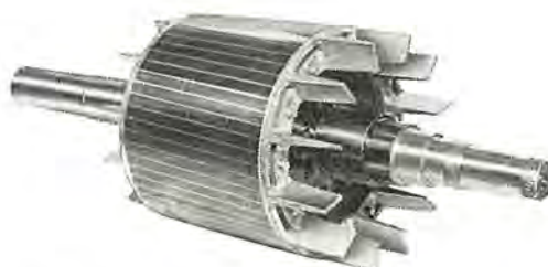
図 4.2 SB-A 形 100 kW 4P 2845 フレームの アルミ 鋳込回転子の外観
