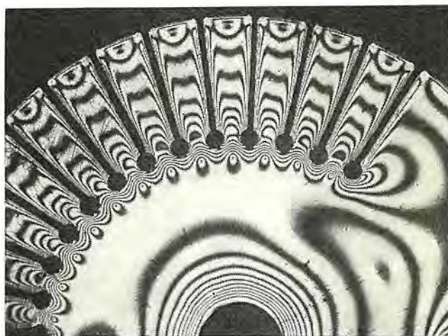
図 5.2 光弾性 (応力凍結法) による 回転円板の応力分布試験の一例 Fig. 5.2 Example of stress distribution test of rotating disk by means of photo elasticity (stress freezing method).
