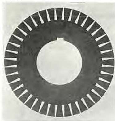
図 5.8 カゴ形回転子の鉄心 Fig. 5.8 Core punching of squirrel cage rotor.
