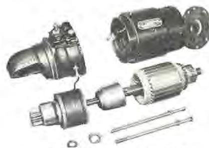
図 2.5 同軸形スタータの分解図
