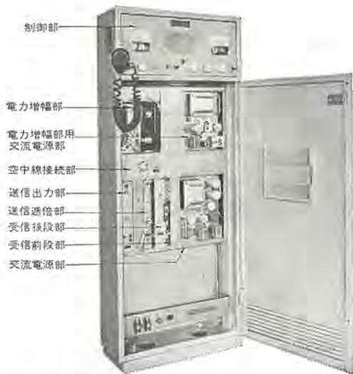
図 3.4 FS-12D 形無線電話装置の外観
