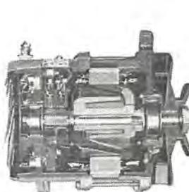
図 2 小形 AC ダイナモ 断面図
