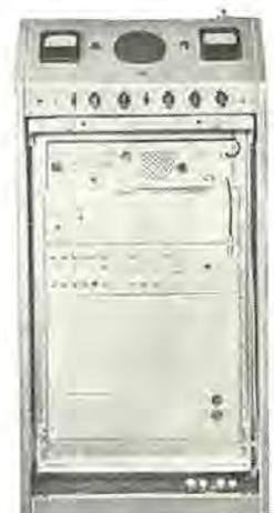
図 2.2 送受信機内部(架正面)
