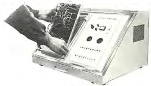
図 4.7 プレパッチボードの装着
