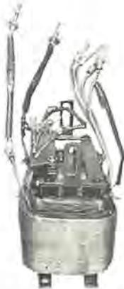
図 5.4 短絡破壊コイル状況
