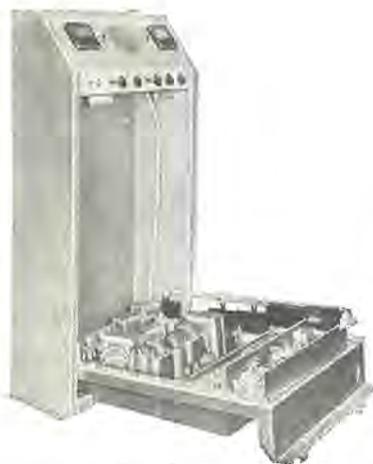
図 2.3 送受信機内部 (架後面)
