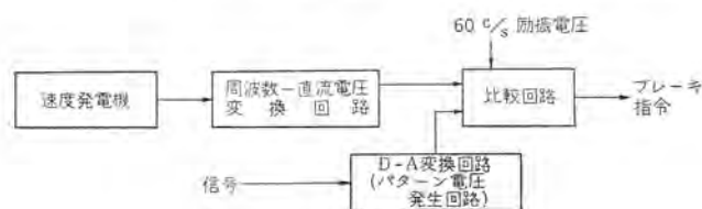
図 4.5 照査部 B ブロック線図 Fig. 4.5 Block diagram of speed checker B.
