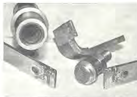
図 4.6 10 4 回負荷 シュ断試験後の接触子 Fig. 4.6 Contacts after 10 4 times load current interrupting tests.
