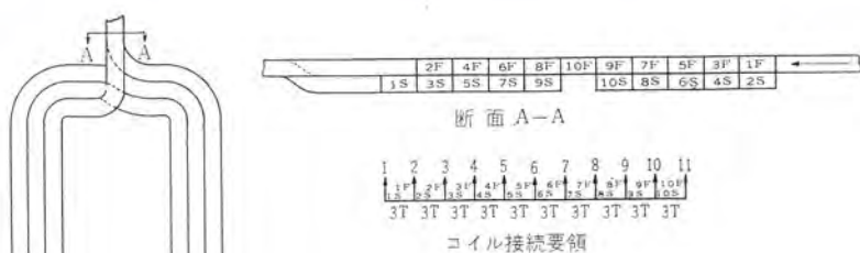
図 5.2 タップコイル巻方図 Fig. 5.2 Details of tap coil.
