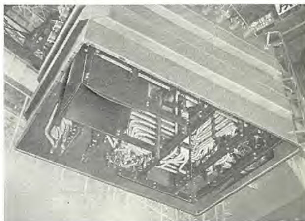
図 5.6 内部 リード 配置 Fig. 5.6 Inside lead arrangement.
