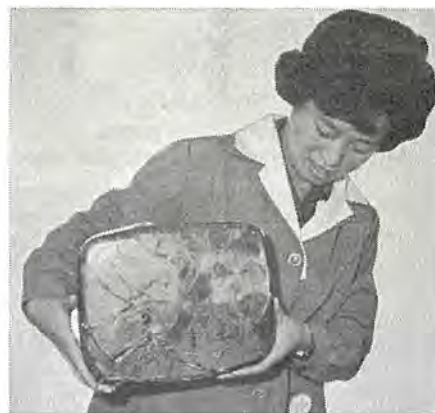
図 5.6 試験後のブラウン管 Fig. 5.6 Picture tube after test.
