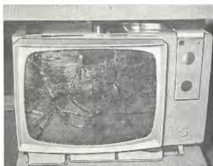
図 5.4 高エネルギー衝撃試験の結果 Fig. 5.4 Result of high energy impact test.
