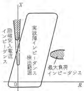
図2.10 交流電化キ電線の故障および負荷特性例 Fig. 2.10 Example of fault and load on AC electrification feeder line
