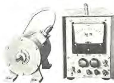
図 2.2 磁気誘導形トルク計外観
