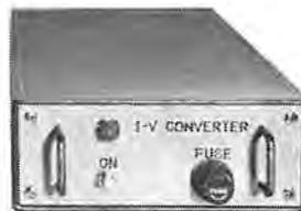
図4 AE-114 形電流電圧変換器
