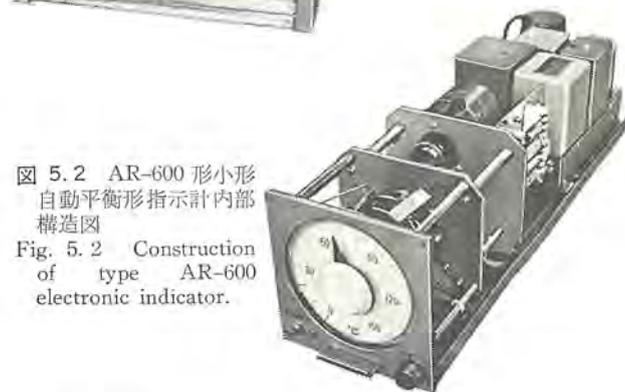
図 5.2 AR-600 形小形自動平衡形指示計内部構造図
