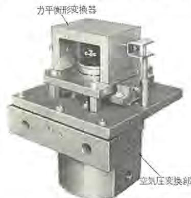
図 7.1 電空変換器の内部
