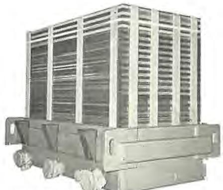
図 3.5 空芯形分路リアクトルシールド鉄心構造
