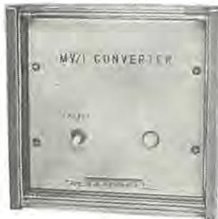
図 4.1 起電力電流変換器
