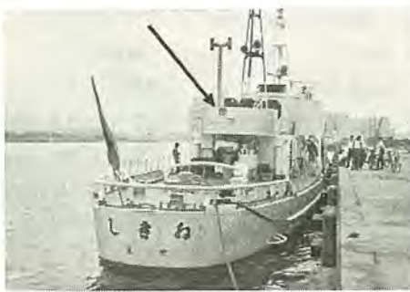
図 11-36 巡視船 “しきね” に接岸用 T. V カメラを取り付けたところ Marine television camera for mooring.
