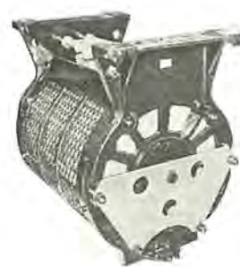
図 7-10 IC200形主平滑リアクトル (新幹線電車用) Type IC200 main smoothing reactor for the JNR's New Tōkaidō Line.
