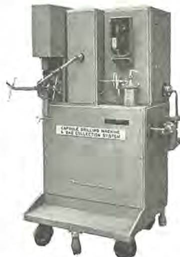
図 19-10 ドリリング・マシン およびガス捕集系 Drilling machine and gas collection system.
