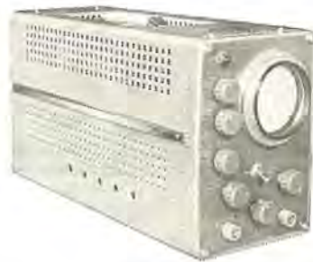
図 12-50 FD-6 形超音波探傷機 Type FD-6 ultrasonic flaw detector.
