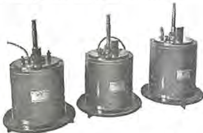
図 4-103 深井戸用水中モートル Submersible water pump motor for bore hole use.
