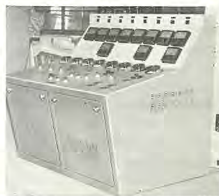
図 4-18 中外炉工業（小西六納め）コーティングライン用主操作盤 Operator's desk for coating line for Chugairo Kogyo Kaisha Ltd. (Konishiroku photo Ind. Co. Ltd.)
