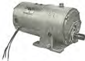
図 4-118 FK-G 形直流減速電動機 100 W, 230 V, 100~10 rpm, 他励 (平 歯車 2 段減速) (事務用機械) FK-G type DC geared motor for business machine.
