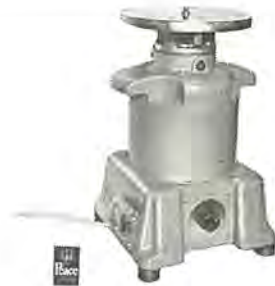
図 4-120 FK 形直流電動機 (シリコン 整 流器内蔵) 120 W, 100 V, (AC 入力), 50/60 c/s, 15,000 rpm, 他励 (小形工作 機用) FK-type DC motor attached with silicon rectifier, for small machine tool.
