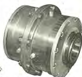
図 7-9 QD250形可トウ歯車継手 (新幹線電車用) Type QD250 gear coupling for the JNR's New Tōkaidō Line.
