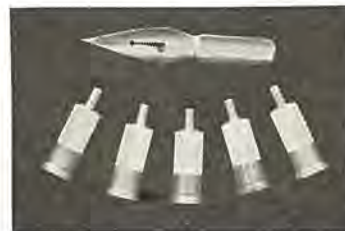
図 20-45 GaAs 拡散形 バラクタダイオード GaAs diffused type varactor diodes.
