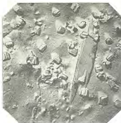
図 20-73 塗装面の劣化による顔料の露出例 (電子顕微鏡写真) Electron microphotos of degradation of painted film.
