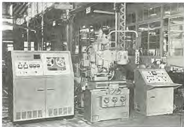
図 12-12 フライス 盤数値制御装置 Numerical contouring control system for machine tools.
