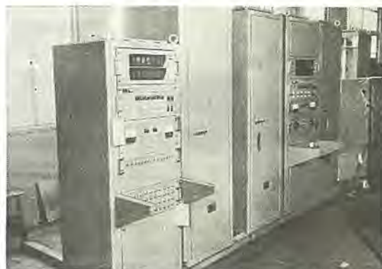
図 11-49 工場試験中のトラッキングテレメータ 空中線 管制装置の一部 A part of control equipments of tracking telemeter antenna under the factory test.
