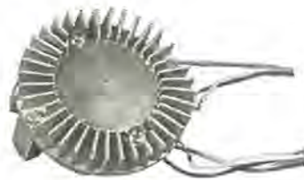
図 8-27 無接点式 トランジスタイグナイタ Non-contact point type transistor igniter.
