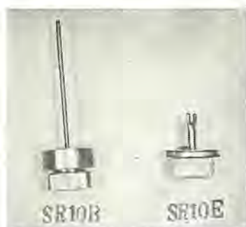
図 13-21 自動車用シリコン 整流素子 Silicon rectifying cells for automobiles.
