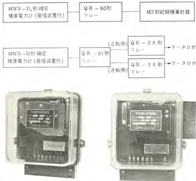
図 14-9 QR-60 形 衝流遠隔伝送用継電器 Type QR-60 impulse transmitting relay.
