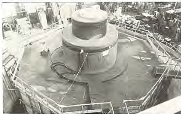
図 1-27 関西電力天ヶ瀬発電所納め 55,000 kVA 水車発電機
