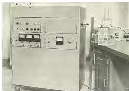
図 20-2 放電研究用 20 kV 方形波発生器 20 kV rectangular pulse generator.
