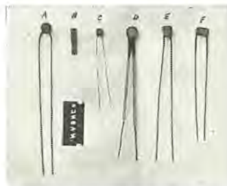
図 20-54 正温度係数サーミスタ (PTC サーミスタ) Positive temperature coefficient thermistor.
