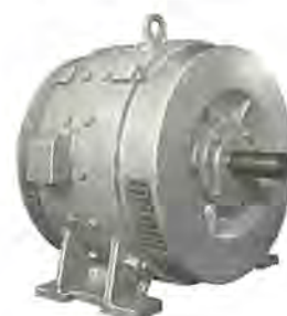
図 4-46 宇部興産納め 60kW 10 極 50/10 t × 24 M クレーンモートル用 100 kg-m 120 rpm AS ブレーキ AS brake 100kg-m for crane motor.
