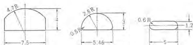
図 18-8 割ピンおよび W クリップ 断面図 Cross section of pin and clip
