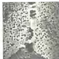
図 20-65 1,065°C×1/2h 溶体化処理後 840°C×20h 空冷後 700°C×20h 2 段時効処理した試料の電子顕微鏡写真 (×10,000) Transmission electron micrograph on thin film of inconel-X (double-age 840°C×20 h+700°C×20 h, after solution-treated 1,065°C×1/2 h).
