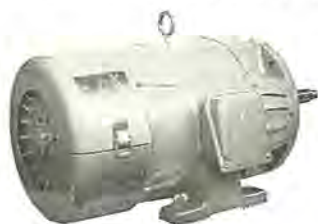
図 4-128 SB-A 形 3.7 kW 4 極三相誘導電動機 EB-5 形直流単板式電磁ブレーキ 付ブレーキトルク 5 kg-m 50/60 c/s 200/220 V 60 分定格 Type SB-A three phase induction motor with type EB-5 single-disk magnetic brake.
