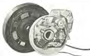
図 8-25 大形エンジン用 FBT-1AR 形 マグネトー Type FBT-1AR magneto.
