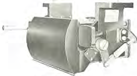
図 7-33 CE-744形 電気連結器 Type CE-744 electric coupler.
