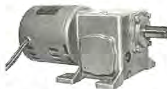
図 4-125 SL-G 形 コンデンサ 減速 モートル 100 W, 100 V, 50/60 c/s, 4 極, 45/55 rpm (ウォーム 2 段減速) (計器用および サーボモートル) SL-G type condenser geared motor for recording meter and servo mechanism.
