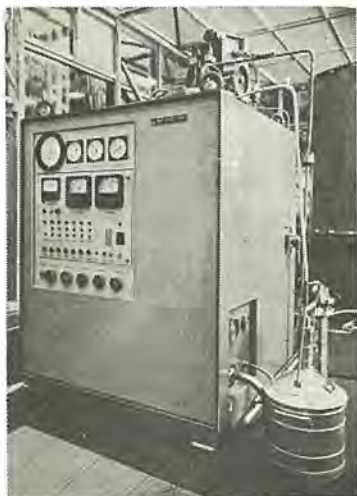
図 20-57 UL-80 形 ヘリウム 液化装置 Type UL-80 helium cryostat.
