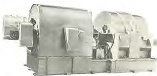
図 4-8 700 kVA, 1,000 c/s 高周波発電機および 780 kW, 3,300 V 巻線形駆動用誘導電動機 700 kVA 1000 c/s high frequency generator driven by induction motor 780 kW 3,300 V wound rotor type.
