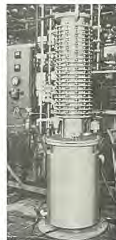
図 20-5 中間電極 22 段の実験用イグナイトロン Experimental ignitron with 22 grading electrodes.
