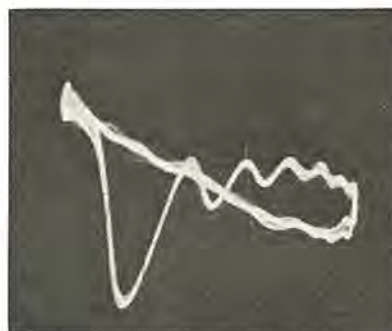
図 20-28 低磁界における二重磁気共鳴信号試料 MnCl_2 0.005 mol/l 水溶液 磁界 30 Oe Enhanced proton resonance signal in aqueous solution of MnCl_2 .
