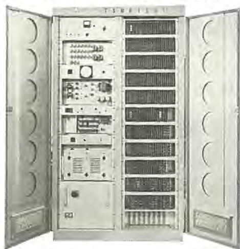
図 12-15 バランシングマシン 制御装置 Automatic controller for dynamic balancing transfer machine.
