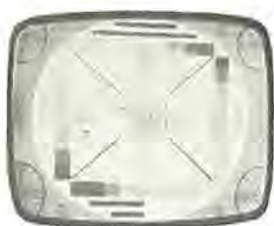
図 13-4 メッシュグリッド 法高 パーベアンス 受像管 Pattern obtained with mesh grid controlled highperveance C. R. T.
