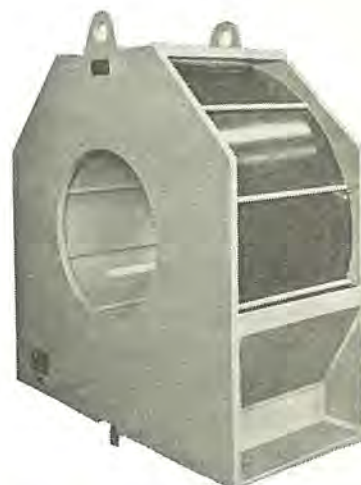
図 19-21 プラズマ 研究用内部冷却式 コイル Inner cooled type coil for plasma researches.
