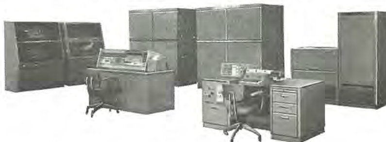
図 12-18 火力プラント用データ処理装置 MELDAP-7371 MELDAP-7371 Data processing system for thermal power plant.
