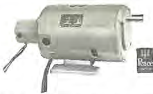
図 4-115 FK-TG 形直流減速電動機 (指速発電機付) 120 W, 55 V, 400~ 20 rpm 他励 (平歯車 2 段減速) (計器 用および サーボモートル) FK-TG type DC geared motor attached with pilot generator, for recording meter and servo mechanism.
