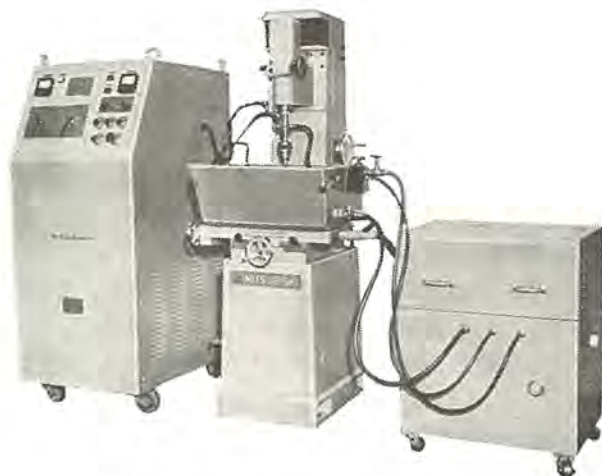
図 12-48 DM-50 B 形三菱 ダイアックス 放電加工機 Type DM-50 B Mitsubishi DIAX electric discharge machine.
