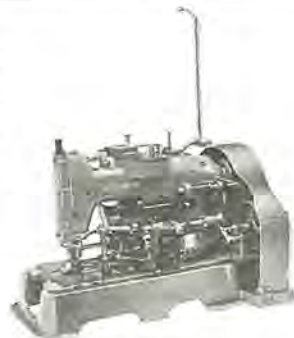
図 17-23 LHI 形工業用 ボタン 穴 カガリミシン Type LHI straight button hole sewing machine.
