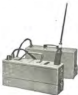
図 12-30 固定局用移動局 B 用 150 Mc/AM無線機 150 Mc/AM equipment for fixed and mobile use.
