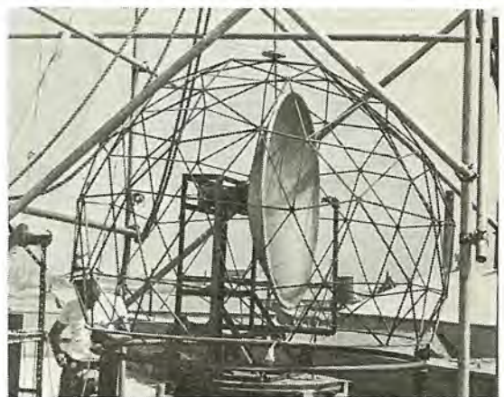
図 20-13 金属骨多面体 レードーム 1/4.2 縮尺電 気試験用模型 1/4.2 size electromagnetic test model for metal space flame radome.
