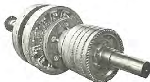
図 1-11 ブラシレスタービン 発電機用回転励磁機 Rotating exciter for brushless excitation system.
