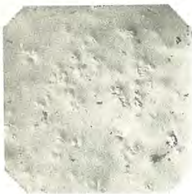
図 20-73 塗装面の劣化による顔料の露出例 (電子顕微鏡写真) Electron microphotos of degradation of painted film.
