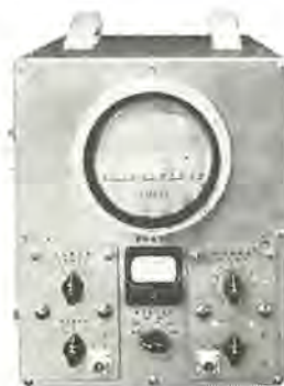
図 12-54 非金属用超音波探傷機 外觀図 Appearance of nonmetallic ultrasonic flaw detector.
