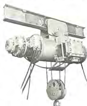
図 4-48 HB-2B-HM 形 超高揚程電気ホイスト(防爆形) Type HB-2B-HM long lift electric hoist (explosion proof) capacity: 2 t, lift: 50 m.
