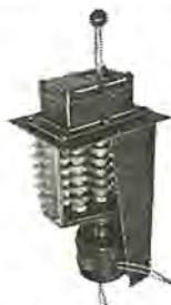
図 4-157 単相誘導器付 2×DM-6 形主幹制御器 Type DM-6 master controller with single phase inductor.
