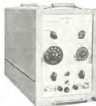
図 12-46 RT-2 形レーダ距離目盛較正器 Type RT-2 radar range calibrator.
