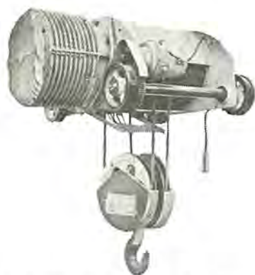
図 4-50 HB-20HR 形電気 ホイスト Type HB-20HR electric hoist capacity: 20 t, lift: 12 m, double rail motor trolley.
