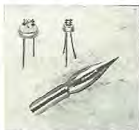
図 20-48 レーザダイオード Mitsubishi GaAs laser diodes.
