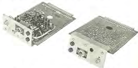
図 12-11 全シリコントランジスタ式制御用演算器 All Si-transistorized operation at apparatus for automatic control.
