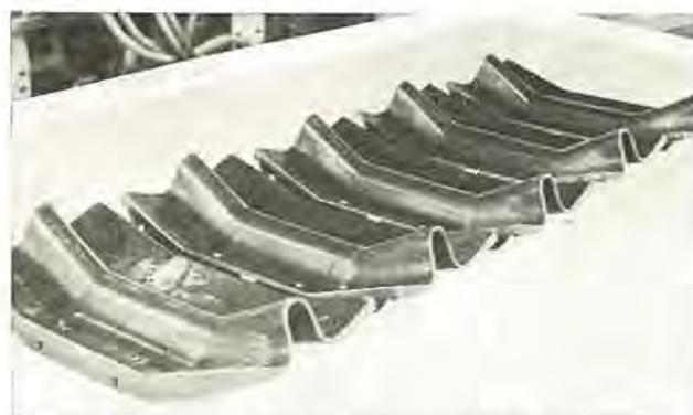
図 18-13 三菱サーペンティクスコンベヤ用ゴムベルト Rubber belt for Mitsubishi serpentic conveyor.
