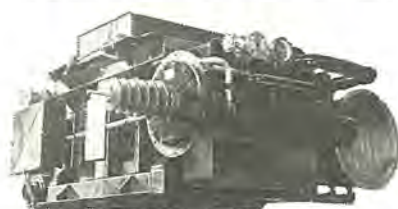
図 7-7 TM200形主変圧器 (新幹線電車用) Type TM200 main transformer for the JNR's New Tōkaidō Line.
