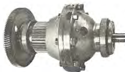
図 6-20 HDK 形 交流揚貨機用差動 歯車 Differential gear for HDK cargo winch.
