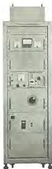
図 14-35 トランジスタ式安定電流電源 Transistorized high stability current supply.
