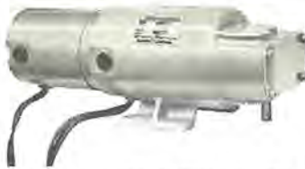
図 4-116 FK-TG 形直流減速電動機 (指 速発電機付) 10 W, 80 V, 25~2.5 rpm, 他励 (平歯車 1 段ウォーム 1 段減速) (サ ーボモートル) FK-TG type DC geared motor attached with pilot generator, for servo mechanism.
