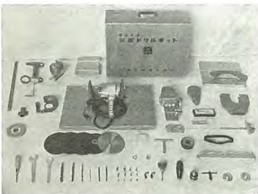
図 4-92 DK-69A 形電気 ドリルキット Type DK-69A electric drill kit.
