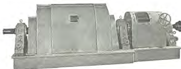
図 4-21 コンプレッサ 用全閉管通風形三相誘導電動機 Three phase induction motor totally enclosed pipe ventilated 3,100 kW 3,300 V 60 cycle 3560 rpm.
