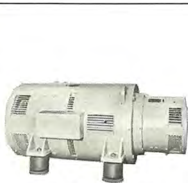
図 4-67 プレーナ駆動用 電源 MG セット 26 kW DCG + 35 kW IM + 3 kW Exc MG set for planer.
