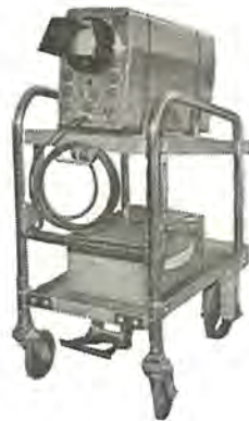
図 12-49 FD-5C 形超音波探傷機 Type FD-5C ultrasonic flaw detector.
