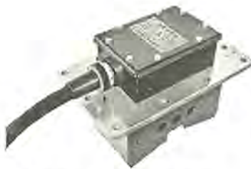
図 7-35 新幹線量産車用 速度発電機 Speed generator for New Tokaido Trunk Line.
