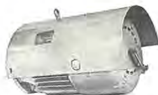
図 4-109 全閉屋外形 コーンブレー キモートル (フランジ形) SEC-F 形 750 W 4 極 1111F フレーム 30 分 定格 200 V 50/60 c/s ブレーキ トルク 80% 以上 Cone brake motor, totally enclosed, out-door use, flange type.
