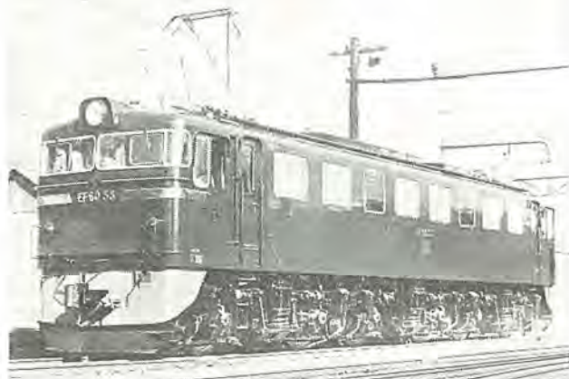
図 7-2 国鉄納め EF60 形直流電気機関車 Type EF60 DC electric locomotive.
