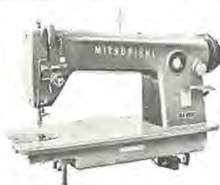
図 17-22 DB 10 形 高速度 工業用本縫 ミシン Type DB 10 high-speed lockstitch machine.
