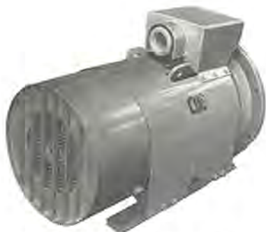
図 5-1 ホーベル用耐圧防爆形誘導電動機 42 kW 4 P 400/440 V 50/60 c/s B 種絶縁, 九検第 3216 号 (圧) 重量 480 kg Pressure-resistant, explosion proof induction motor for use with a hobel 42 kW 4 P 400/440 V 50/60 c/s.
