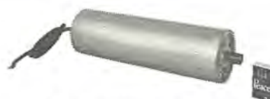
図 4-55 BN-0.1 形 モーターリ 0.1kW 三相 4 極 200/220V 50/60 c/s 連続定格 ベルト 速度 58/70 m/min. ラーリ 径 120 mm 幅 400 mm Type BN-0.1 motor pulley.
