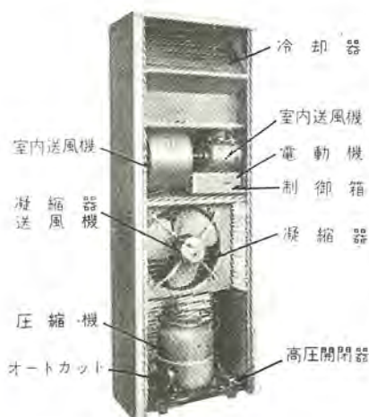
図 17-54 LU-20 形 ルームクーラー 内部構造 Interior construction of room cooler.
