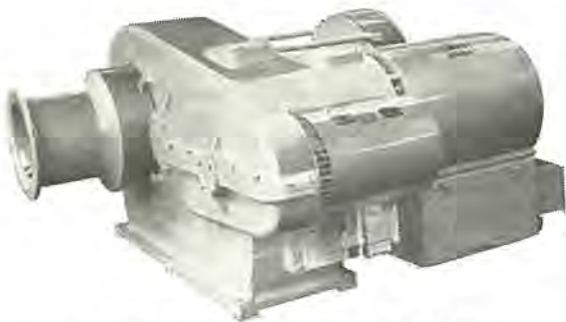
図 6-23 HDK 形 3t×40 m 交流揚貨機 Type HDK 3t×40 m AC cargo winch.
