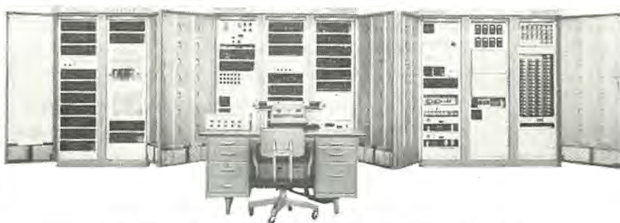
図 12-17 火力プラント用データ処理装置 MELDAP-6261 ほか MELDAP-6261 Data processing for thermal power plant.
