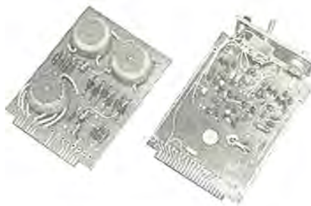
図 3-2 位相変調器 (左) および トランジスタ増幅器 (右) Pulse phase modulator and transistor amplifier.
