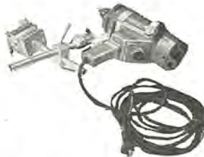
図 4-119 FK 形直流電動機 (シリコン 整 流器内蔵) 50 W, 100 V, (AC 入力), 50/60 c/s, 1,000~500 rpm, 分巻 (万 能 カクハン用) FK-type DC motor attached with silicon rectifier, for mixing machine.
