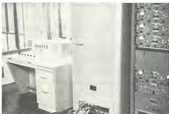
図 12-22 G-20 直結データ処理装置 G-20 Direct coupling automatic data reduction processing system.
