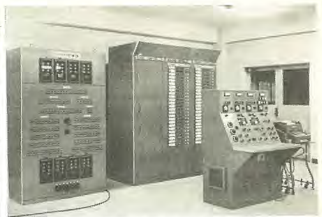
図 12-35 三菱シーケンスコントローラ Sequence controller for circuit breaker testing device.
