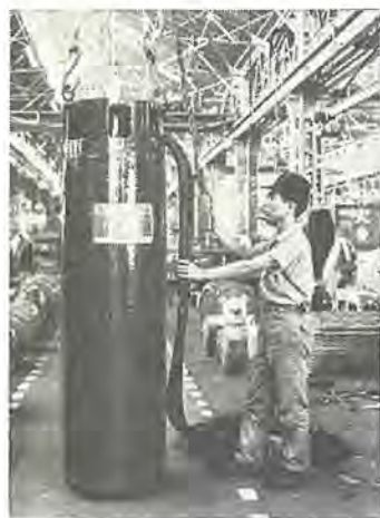
図 4-106 190 kW 水中モートル The Greatest submersible water pump motor in Japan. 190 kW 4P.
