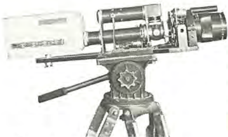
図 11-35 撮像機に十字線入り スーム レンズを取り付けたところ Camera and zoom lens with cross line.
