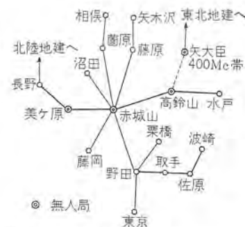
図 11-18 関東地方建設局 マイクロ中継回線図 Microwave network KANTO regional construction bureau.
