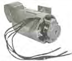
図 4-117 FK-G 形直流減速電動機 10 W, 40 V, 60~6 rpm, 他励 (ウォーム 1 段減速) (事務用機械) FK-G type DC geared motor for business machine.
