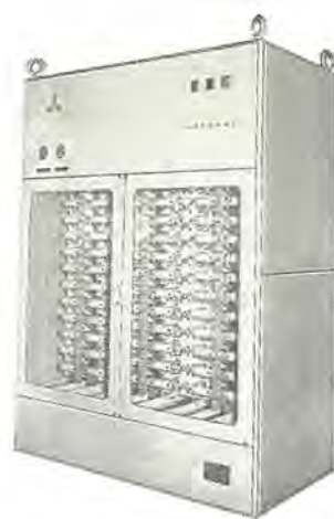
図 3-3 三菱金属納め 4,815 kW 535 V 9,000 A SF-2B24C 形 風冷式シリコン整流器 Type "SF-2B24C" forced-air- cooled silicon rectifier.
