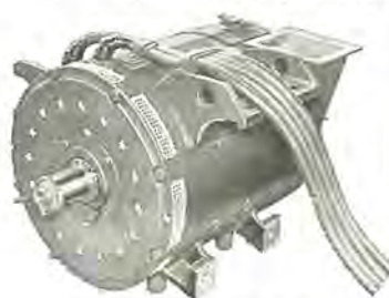
図 7-8 MT200形主電動機 (新幹線電車用) Type MT200 main motor for the JNR's New Tōkaidō Line.
