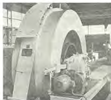
図 4-22 東北肥料納め圧縮機用 2,600 kW 同期電動機 2,600 kW synchronous motor for reciprocating compressor.
