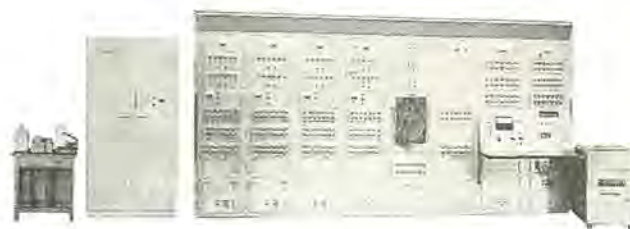
東北地方建設局納め 図 12-4 EA-7114 形洪水計算シミュレータ Flood simulator model EA-7114.
