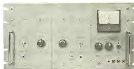
図 20-42 ホール 発生器応用乗算器 Multiplier with hall generator.
