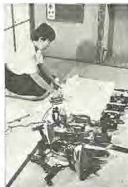
図 20-69 アイロンの実用試験 Actual operation test of electric irons.
