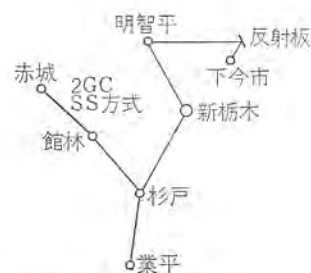
図 11-17 東武鉄道 マイクロ中継回線図 Block diagram of microwave network of Tōbu railway Co.
