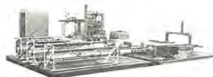
図 11-21 組合試験中のフェライト無限移相器 (手前) とデジタル制御装置 (向側) Ferrite phasemitter under the factory test.
