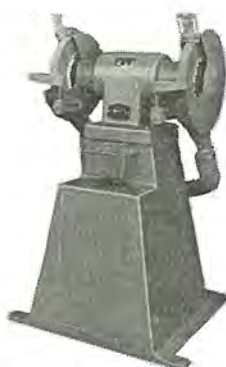
図 4-81 TG-1305T-2 形 305 mm 床上用電気グラインダ (集じん装置付) Type TG-1305T-2 305 mm electric grinder (with dust collector).
