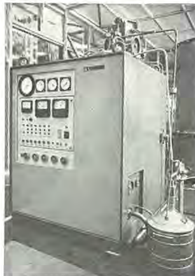
図 10-21 UL-80 形 ヘリウム 液化機本体外観 Exterior view of helium liquidfire.
