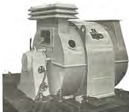
図 6-1 785 kVA 1,800 rpm 自動タービン発電機 785 kVA 1,800 rpm self-excited turbine generator.
