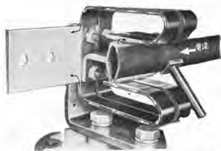
図2 リバース・ルーラ形コンタクトの構造図
