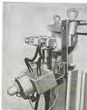
図 3.4 過負荷表示器取付状態 Fig. 3.4 Mounting of overload indicator.
