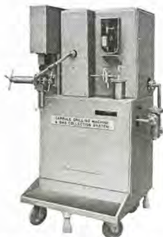
図 3.4 カプセルドリリングマシン および ガス 捕集系 Fig. 3.4 Capsule drilling machine and gas collection system
