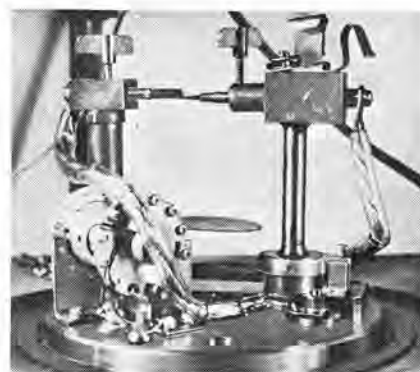
図 3.3 ベルジャー内の蒸着機構
