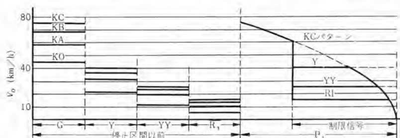
図 5.15 制限信号による指令パターンの変化 Fig. 5.15 Changes of instructions pattern by limiting signal.
