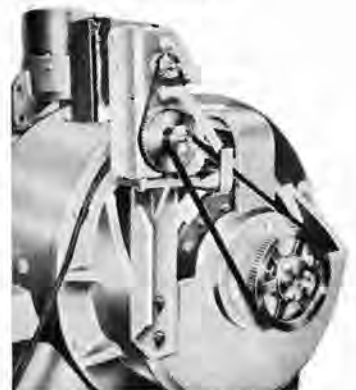
図 2.5 DMR 形速度調整器原理図 Fig. 2.5 Schematic of type DMR velocity transducer.
