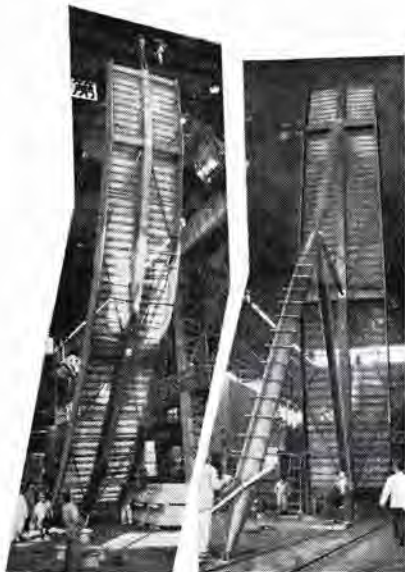
図 3.6 反射鏡の強度試験 Fig. 3.6 Strength test of mirror section.
