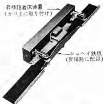
図 2.13 昇降路着床装置およびシールド鉄板 Fig. 2.13 Hatch transducer and shield plate.
