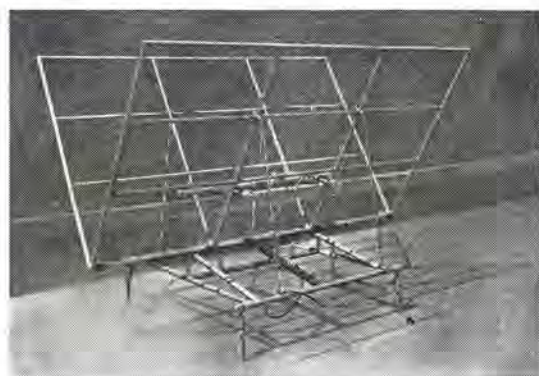
図 3.1 ダイポール2素子 60°コーナリフレクタアンテナの外観 Fig. 3.1 Exterior view of a 60° corner-reflector antenna with 2 dipoles.
