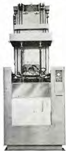
図 3.1 10 kc 150 kW アクスルシャフト 焼入装置
