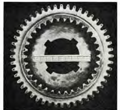
図 3.27 ピニオンギヤ 焼入 パターン
