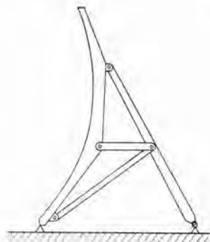
図 2.2 支柱組立式反射鏡 Fig. 2.2 Pipe frame type mirror.
