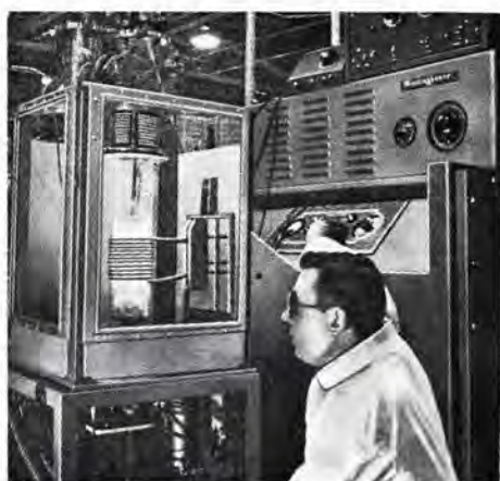
図 3.43 シリコン単結晶引上げ装置
