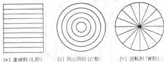
図 2.3 ムービング・シートの基本的形態 Fig. 2.3 Basic form of moving sheet.
