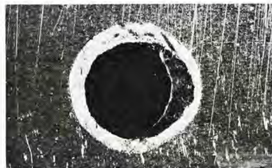
図 2.6 同上 引張せん断試験における破面 ( \times 5 ) Fig. 2.6 Appearance of tensile-shear tested specimen welded by the new method.
