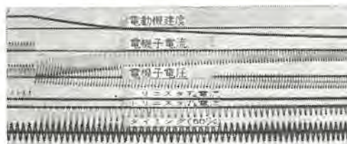
図 3.4 モータ急速反転時のオシログラム Fig. 3.4 Oscillogram of quick reversing of motor rotation.
