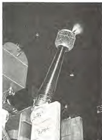
工場において誘導試験中の オーストラリア向け 145 MVA 単巻変圧器
