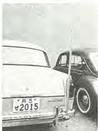
図 1.1 自動車の緩衝器に取付けた 400Mc 帯垂直偏波無指向性高利得アンテナ
