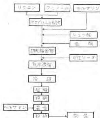
図 2.4 リグニン 樹脂製造 フローシート Fig. 2.4 Flow-sheet (Manufacturing Lignin-resin).
