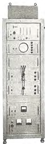
図 3.4 図 3.3 の速中性子カウンタの調整装置の外観 Fig. 3.4 Outside view of an apparatus for adjustment of a fast neutron counter shown in Fig. 3.3.
