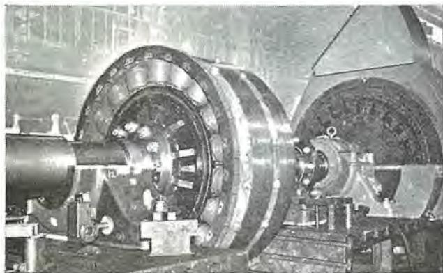
工場試験中の 2,250 kW スペリ電磁カップリング
