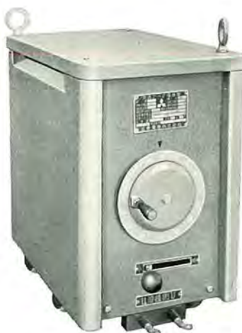
MA-300 形交流アーク溶接機 可動鉄心形 (普及品)
