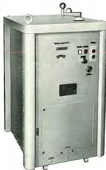
TD-200 形直流アーク溶接機 (トランスアクター シリコン整流器形)
