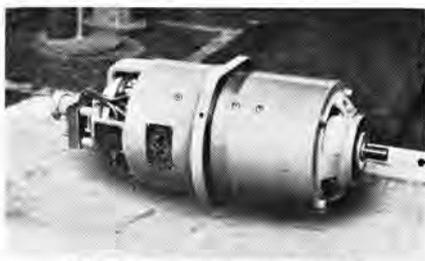
図 3.3 送り装置駆動用 DCM
