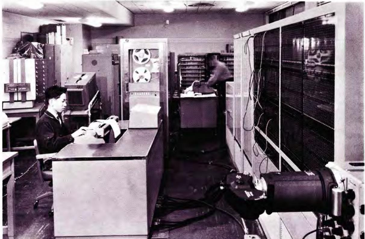
この装置は鉄道技術研究所のご指導により製作したもので当社の汎用計算機MELCOM 1102とパッチ・ボード・プログラム方式の大規模な計数形微分解析機(Digital Differential Analyzer-DDA)とを特長のある方式で結合したものである。列車群、貨車群の制御ないし列車ダイヤの編成、変電所負荷容量分担問題、新機関車の採用による運転特性などをシミュレーション法により解析することを主目的としている。まずDDAの部分で線路状態、列車の運転特性などの条件をうけ実際の列車群や貨車群を付属出力機器に送り表示させ、一方汎用計算機の部分では、実際の制御機またはシミュレーションの対象となる制御機器の部分を模擬し計算機とDDAが密接に相互の特長を生かしながら協同動作し、その機能を飛躍的に拡張させている。このように汎用計算機とDDAを組合せ非常に複雑な制御システムの計算を容易な操作でしかも高い精度で解析できる世界的にも類例をみない新しい計算機で国鉄近代化の一助となることが期待されている。
