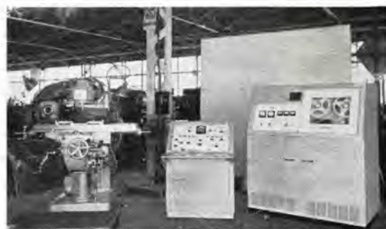
図 12-4 3軸フライス盤数値制御装置 (MELDAS-1313) Three axis milling machine and numerical controller.
