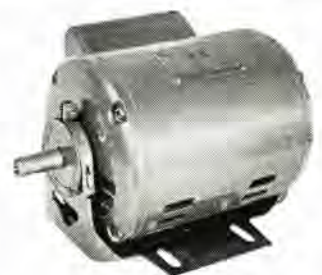
図 4-78 SP-F 形 単相誘導電動機（分相起動形、フランジ形） 200 W 100 V 50/60 c/s 4 極 Type SP-F Single phase induction motor. (Split-phase start with flange)
