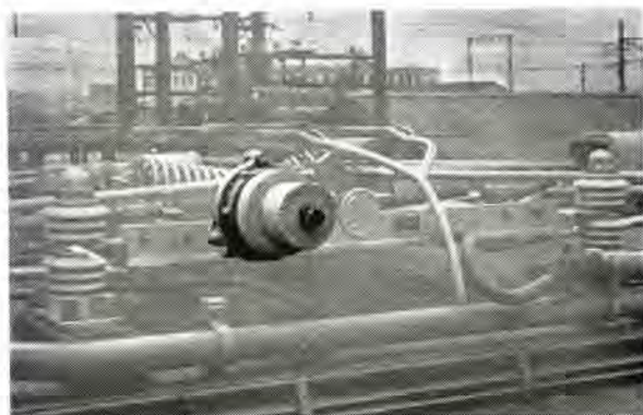
図 7-25 京浜急行納めパンタグラフ 取付 PR 形直流避雷器 Type PR DC lightning arrester attached to the pantograph.
