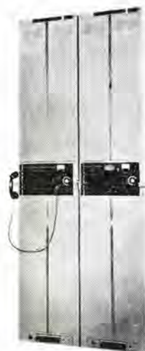
図 11-25 MX-3J 形 60CH 容量搬送電話端局装置 Type MX-3J 60CH capa- city multiplex equipment.
