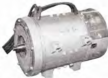
図 19-24 MB-3053-A 形超高速主電動機 Type MB-3053-A super-high-speed traction motor.
