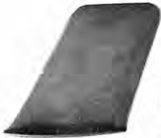
図 19-4 航空機用アンテナ研究 の成果-VHF 通信用小形軽 量広帯域ブレード・アンテナ
