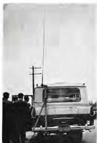
図 11-21 通話試験用 移動局 A mobile station for a radio telephone test.
