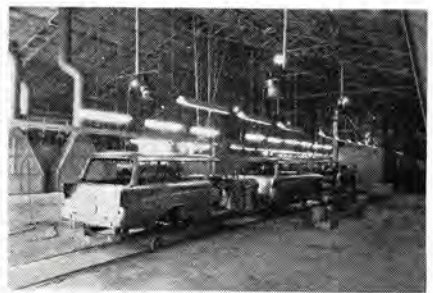
㉜ プリンス自動車工業 三鷹工場 (東京) FH-492 5 m 間隔につり下げ 水平作業面 照度 500 lx、鉛直作業面照度 450~500 lx.
