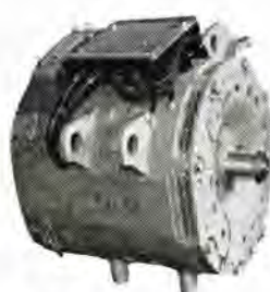
図 7-8 MB-3054-A 形 75 kW 主電動機 Type MB-3054-A 75 kW traction motor.
