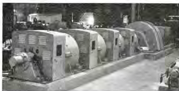
図 4-1 八幡製鉄(株)納め 2 スタンドスキンパスミル 用電動発電機
