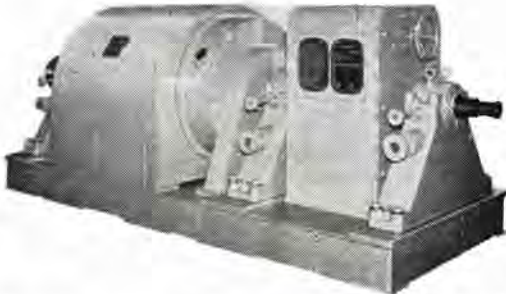
図 4-12 大阪瓦斯納め 1,750 kW 3,300 V 60 c/s 2 極 3,600 rpm 誘導電動機 巻線形閉鎖他力通風形 1,750 kW Wound rotor enclosed forced ventilated induction motor.
