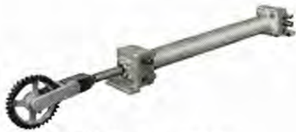
図 7-28 新形戸閉機械 New type door engine.
