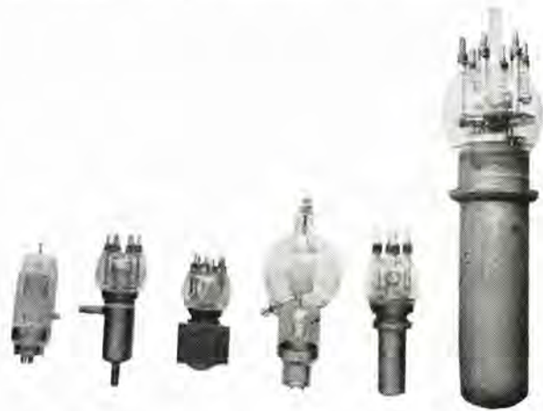
図13-6 三菱工業用送信管(左から3T12, 8T15, 7T36R, 5T30, 8T89, 8T95) Mitsubishi industrial transmitting tubes.
