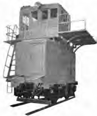
図 7-3 尼崎 コークス 納め 20 t 消火車けん引用機関 車 20 ton quenching locomotive for the Amagasaki Coke Co.
