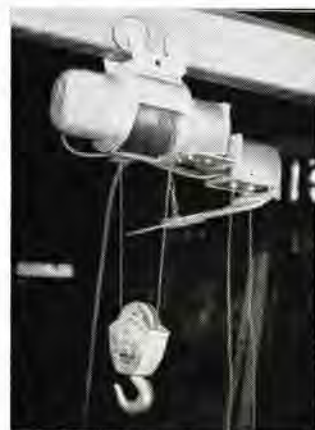
図 4-39 HJ-1.5 LP 形電気ホスト 200kg 低揚程手押し走行形 Type HJ-1.5 LP electric hoist 200kg low head, push trolley.
