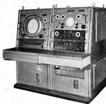
図 11-35 RC-4 形 指示装置 RC-4 type master indicator group.
