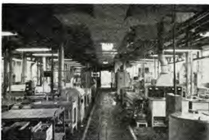
㉝ 横河電機 三鷹工場メッキ工場 (東京) FHR-C 402 (FLR-40×2) 総塩化ビニル製 FHR-C 403 (FLR-40×3) 総塩化ビニル製 平均照度 400~200 lx.
