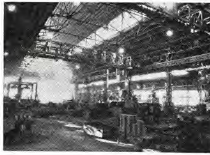
㉘ 三菱日本重工業 東京自動車製作所 川崎工場 (神奈川) 鋳物工場 床面積 22.5 m 2 (5×4.5 m) ご とに銀白色 HRF-400 XT×1 灯の割で取 付けられている。全部で 46 灯、同数の電 球が併用され、作業面で 110~40 lx、光源 の高さ 8 m である。
