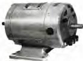
図 4-83 直流電動機 50 W 100 V 2,000 rpm 2 極 分巻 連続定格 50 W Shunt wound DC motor.
