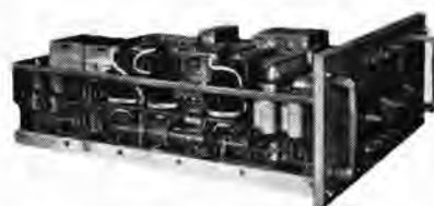
図 12-16 EA-9101 形過渡安定度計算機 Transient stability computer. (type EA-9101)
