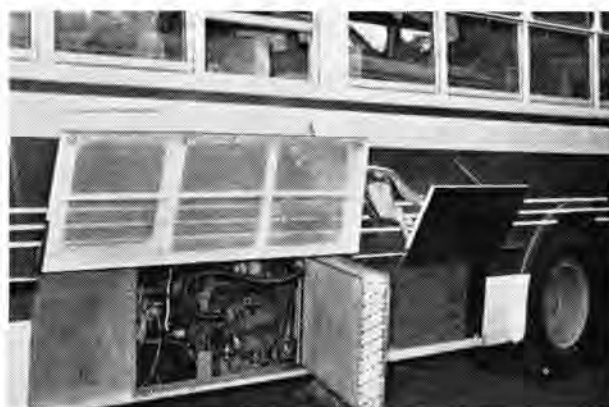
図 10-19 バス冷房装置を取付けたところ
