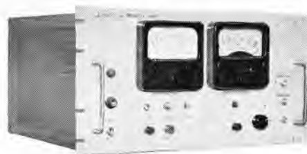
図 14-39 Log N -炉周期増幅器 Log N -period amplifier.
