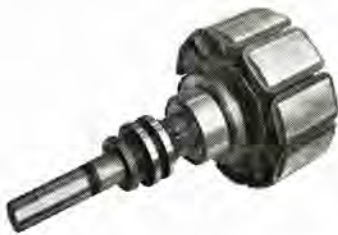
図 4-73 1.5 kW 400 V 50 c/s 1,250~210 rpm AS モータ 1.5 kW AS motor.
