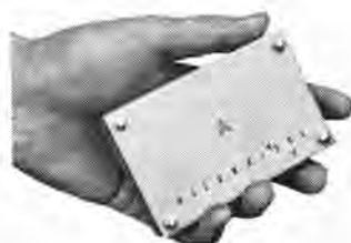
図 11-30 三菱 2 チャンネル 医学用 テレメータ 送信機 2 Channel medical telemetering transmitter type PT-210.
