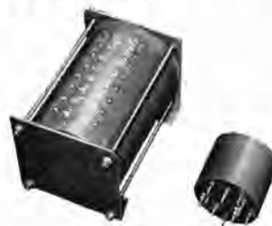
図 19-13 磁気増幅器式 パイロットモータ制御器 Magnetic amplifier for pilot motor control.
