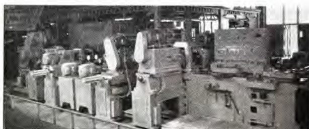
図 4-50 電動機フレーム用トランスファーマシン Transfer machine for machining motor frame.
