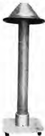
図 19-1 シャヘイ付抵抗分圧器 Shielded voltage divider.
