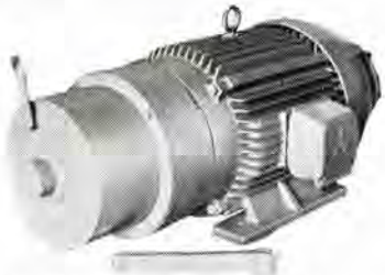
図 4-70 AD-2020 形交流円板形電磁ブレーキ付 SF-A 形 19 kW 4 極三相誘導電動機 60 c/s 440 V 30 分定格 Type SF-A Three phase induction motor with AD2020 disc type AC magnetic brake.
