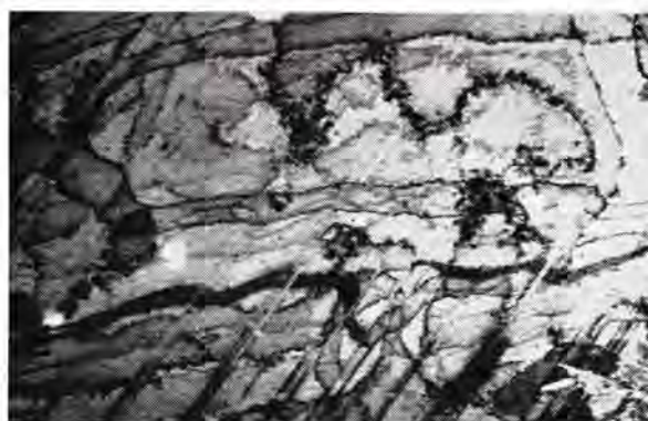
図 19-27 18-8 不銹鋼薄膜の電子顕微鏡写真( \times 15,000 \times 3/4 ) (1,050°C, 10 min, 溶体化後 20%圧延)
