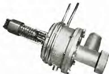
図 14-20 超高真空質量分析計用二次電子増倍管（改良形） New electron multiplier for the high vacuum mass spectrometer.
