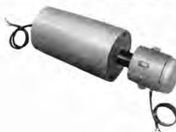
図 4-42 BN-1.5 形三相 200/220 V 50/60 c/s 4 極 電磁ブレーキ付ベルト速度 42/50 m/min Motor pulley with magnetic brake.
