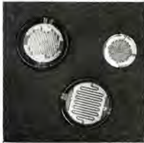
図 19-20 樹脂形光電導セル Plastic mold type photoconductive cell.
