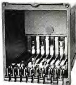
図 2-47 M-A 形 ケース (カバー をはずしたところ) Type M-A relay case (Uncovered view).
