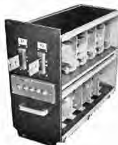
図 7-6 シリコン 整流器 ユニット Silicon diodes unit.
