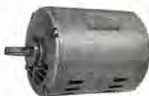
図 4-76 SP-R 形 単相誘導電動機（分相起動形足なし） 200 W 100 V 50/60 c/s 4 極 Type SP-R Single phase induction motor. (Split-phase start, without foot)
