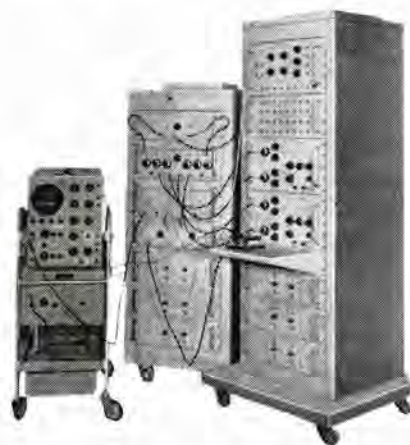
図 19-14 記憶用磁心パルス特性直視装置 Tracer of pulse response of memory cores.
