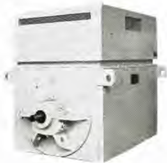
図 4-68 ターボ冷凍機用誘導電動機 HB (開放保護形サイレンサおよび防音カバー付) 200 kW 6,600 V 60 c/s 2 極 Type HB induction motor with silencer for turbo refrigerator.
