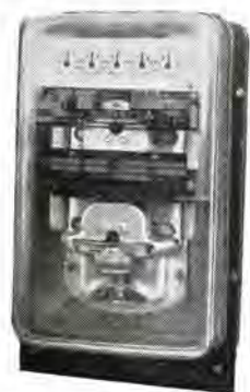
図 14-3 MWS-Dr 形精密積算電力計 (発信装置付) Type MWS-Dr precision watthour meter.
