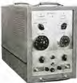
図 12-29 RT-2 形 レーダ用距離目盛校正器 RT-2 radar range calibrator.
