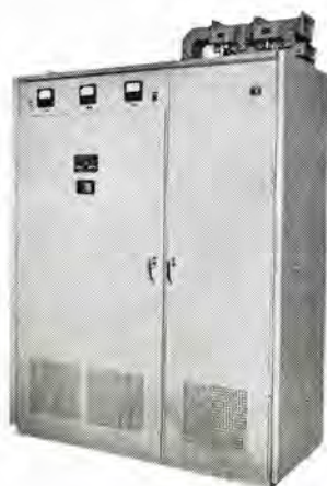
図 11-42 GTR-1 形 レーダ 送受信装置 (パラメトリック 増 幅器付) Type GTR-1 radar trans- mitter-receiver with low noise parametric ampli- fier.
