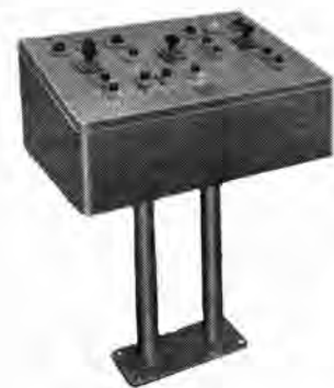
図 4-10 ケーク精練機用操作盤 Operating panel of cake refining machine.
