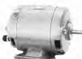
図 4-84 単相整流子電動機 50 W 100 V 50/60 c/s 3,000~600 rpm 4 極直巻 連続定格 Single phase commutator motor.
