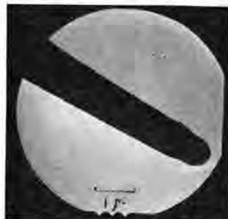
図 19-15 針状タングステン陰極の電子顕微鏡写真 ( \times 9,000 \times 4/5 ) Electron microscope shadowgraph of typical field emitter.
