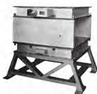
図 12-27 KK-1 形金属検出装置 検出コイル Type KK-1 metal detector coil apparatus.
