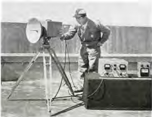
図 12-30 レーダ・スピード・メータ Radar speed meter.
