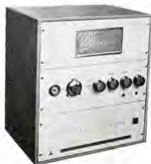
図 11-31 三菱 2 チャンネル 医学用 テレメータ 受信機 2 Channel medical telemetering receiver type PT-210.
