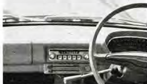
図 8-32 コンテッサに取付けられた AR-590 形 Type AR-590 autoradio mounted on a motor car.
