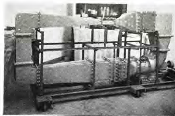
図 14-17 自動温度補償形サーミスタ風速計の試験用風洞 Test wind tunnel for automatic temperature compensation type thermistor air speed meter.
