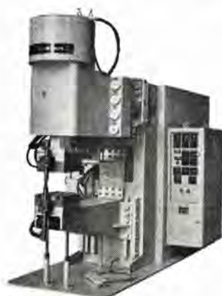
図 4-124 三相 150 kVA スポット兼用プロセクション溶接機 3 phase 150 kVA spot-projection welder.
