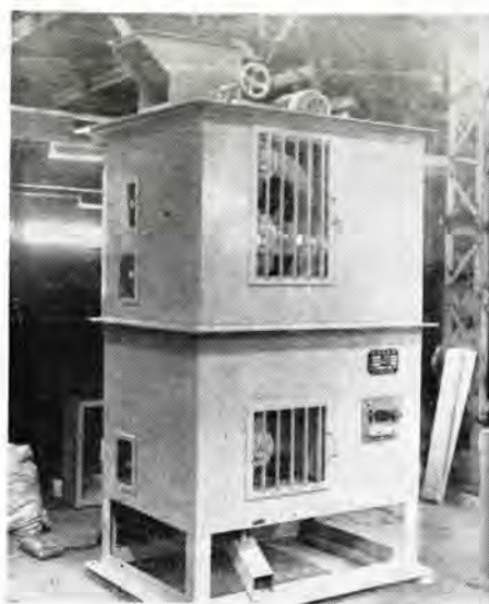
図 5-9 HM-10 形磁気選別機 Type HM-10 magnetic separator.
