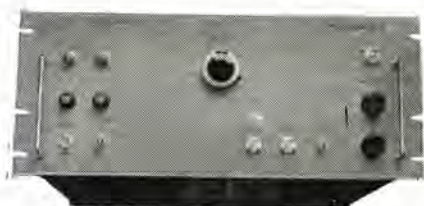
図 14-37 比例増幅器 (Non-Overload Type) Non-Overload Type linear amplifier.
