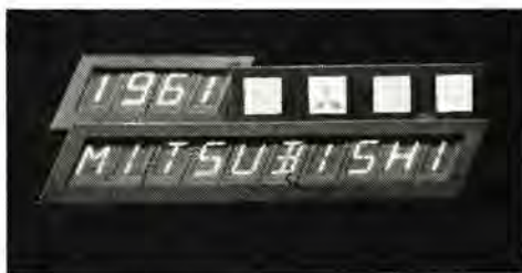
図 19-21 EL ケイ光板および EL 表示板 Electroluminescence Panels and readout lamps.
