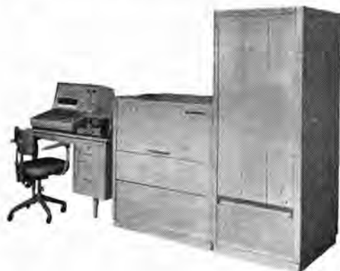
図 12-2 操車場自動制御用 デジタル計算機 Digital computer for yard automatic control.
