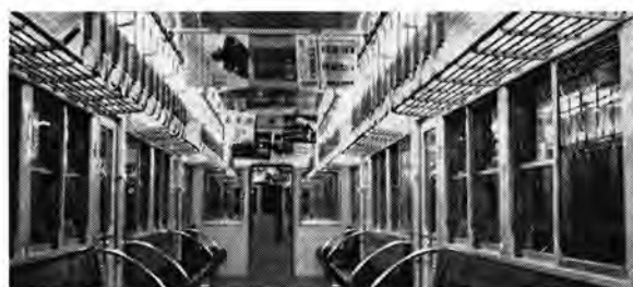
図 7-32 阪神電気鉄道納め 40 W 1 灯 12 連続および 13 連続 2 列配置 アクリライトカバー No. 432 110 V 60 c/s ラビッド スタート方式 Interior of electric car for Hanshin Railway.
