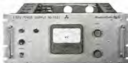
図 14-29 高圧安定化電源 1.5 kV Power supply ND-1521.
