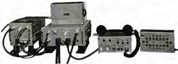
図 11-8 150 Mc A 種 3 形 25 W 無線機 Type A-3 150 Mc 25 W mobile radio equipment.
