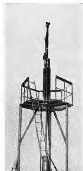
図 18-4 磁気ジャック形制御棒駆動装置 Magnetic jack type control rod drive mechanism.
