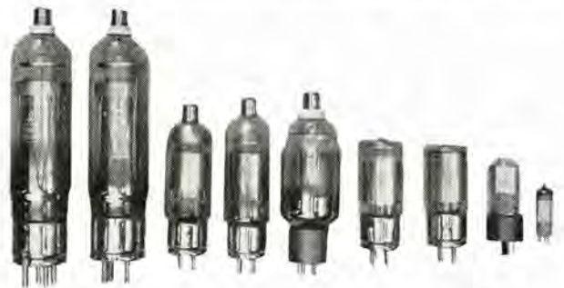
図 13-5 キセノンガス入りサイラトロン および整流管 Xenongas filled Thyratron and rectifier tubes.
