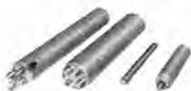
図 18-8 試作した中性子検出器 左から C.I.C., P.C.P., BF 3 , Fission counter.
