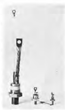
図 13-14 シリコン 制御整流素子 (CR 100, CR 20, CR 5) Silicon controlled rectifier (CR 100, CR 20, CR 5)
