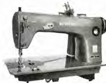
図 16-42 DM 2 形 工業用 2 本針二重環縫ミシン Type DM 2 chain stitch sewing machine.
