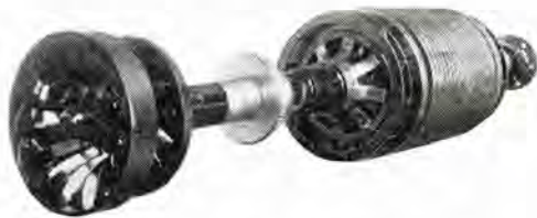
図 1-31 1,800kW 誘導発電機回転子 1,800 kW induction generator rotor.
