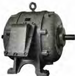
図 4-35 信越化学納め 7.5 kW 三相誘導電動機 クレーン 用 カゴ 形全閉形 200 V 50 c/s 735/365 rpm 7.5 kW Totally enclosed squirrel cago induction motor.
