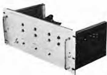
図 14-15 トランジスタ走査 温度制御装置 Transistor scanning temperature controller.
