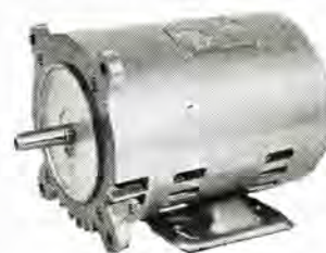
図 4-77 SC-S 形 単相誘導電動機（コンデンサ 起動形、防振形） 200 W 100 V 50/60 c/s 4 極 Type SC-S Single phase induction motor. (Condenser start resilient mounting)
