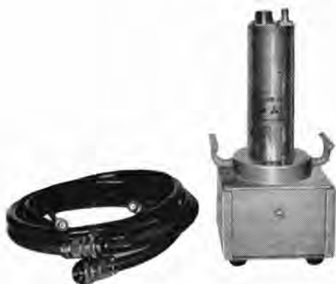
図 14-36 GM カウンタヘッド GM counter head ND-1123.
