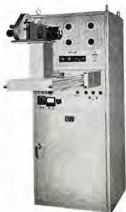
図 11-44 GTR-1 形 レーダ・データ 撮影装置 Type GTR-1 radar data movie recorder.
