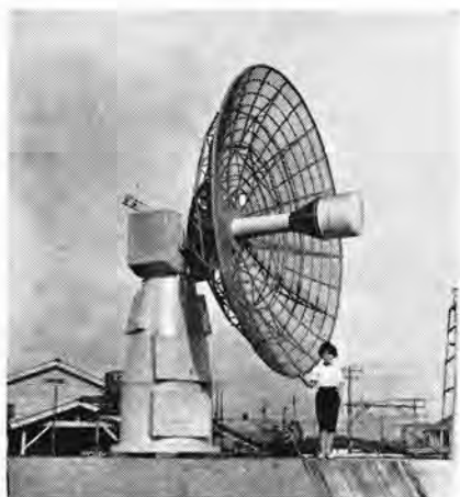
図 11-41 GTR-1 形 レーダ 4 mφ 空中線 Type GTR-1 radar 4 m dia antenna.
