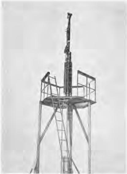
図 4.2 試験架台上の駆動装置
