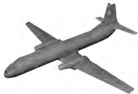
図 2.4 放射指向特性測定用中形輸送機 YS-11 20 分の 1 縮尺模型
