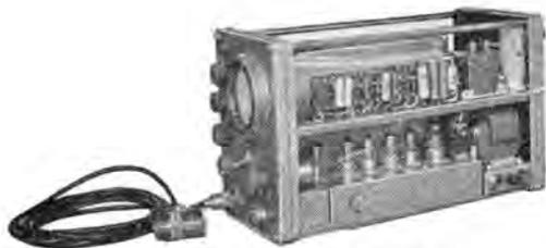
図 2.2 (a) FD-6 形探傷機右側面内部構造
