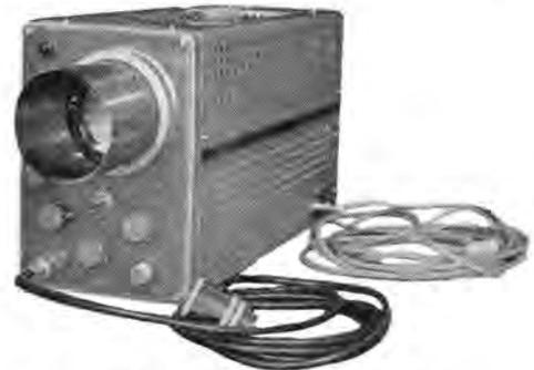
図 2.1 FD-6 形超音波探傷機
