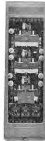
図 2.1 KZB-M 形インピーダンス継電器
