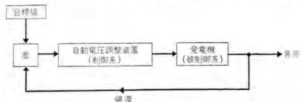
図 2.4 自動制御回路系統図
