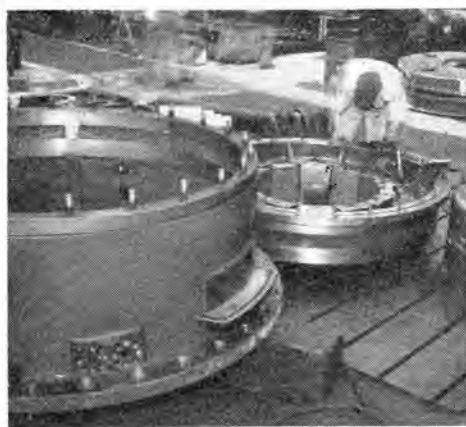
図 5.7 主軸受および軸受ささえ Fig. 5.7 Main bearing and bearing support.
