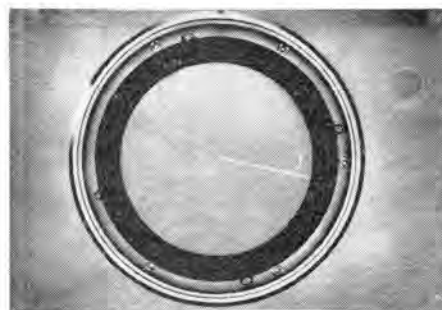
図 4.3 (b) 実際のレーダ指示器較正状況 4.3C の状態より遅延時間の調整を行ない、較正目盛を零距离に合わせたとき
