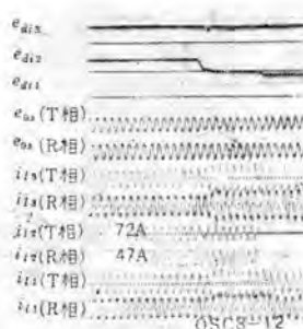
図 7.12 山一器の並列運転試験の オシログラム
