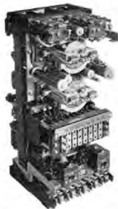
図 3.5 HUB-2-M 形 比率差動継電器内部 Fig. 3.5 Interior of type HUB-2-M relay.
