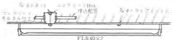
② コンクリート天井への直取付(パイラりの場合はハンガを同様取付ける)
