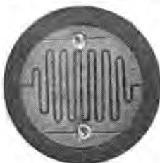
図 2.2 CdS セル内部形状 Fig. 2.2 CdS cell interior shape.
