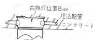
② ボイラ部屋外白熱灯取付け (コンクリート打込の場合) (c) 白熱灯
