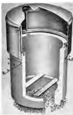
図 1 コンクリートパイラの上に鉄製の容器とカバーを設けた半埋込式の変圧器容器
