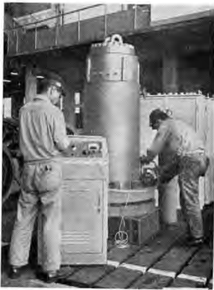
図 4.4 350 kVA キャンドモータヘリウム漏洩検知器による漏れ検出 Fig. 4.4 Leakage test of 350 kVA canned motor with helium leakage detector.
