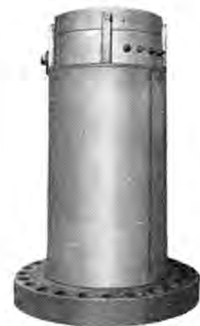
図 3.4 350 kVA キャンドモータポンプ モータケーシング Fig. 3.4 Motor casing of canned motor pump.
