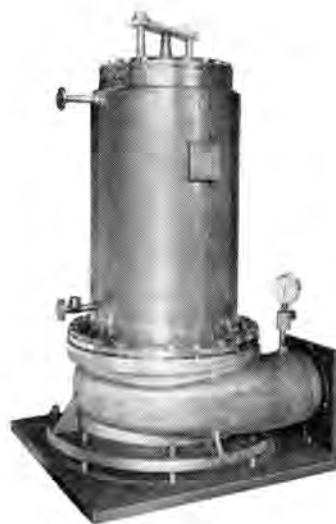
図 4.2 90 kW キャンドモータ総合漏れ試験
