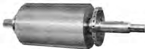
図 3.2 キャンドモータポンプロータ
