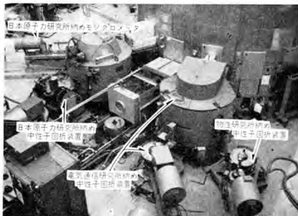
JRR-2 原子炉に据付けられた中性子回折装置
