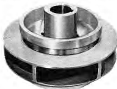
図 3.3 キャンドモータポンプ用ポンプインペラ
