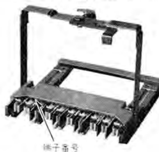
図 4.3 M-A 形継電器箱のカバーをはずし本体を引き出したところ Fig. 4.3 Test switches and current transformer secondary circuit shorting pieces.
