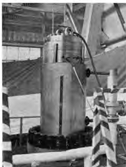
図 1.1 テストループに据付けられた 350 kVA キャンドモータポンプ
