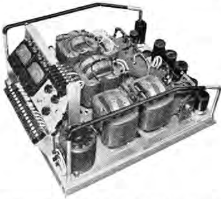
図 7.6 三軸フライス盤用連続切削数値制御装置電源部
