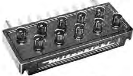
図 7.1 10点試験用プラグ Fig. 7.1 Ten circuit test plug.
