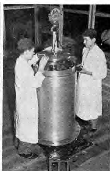
図 5.5 ジンアイのない部屋で組立中の キャンドモータ
