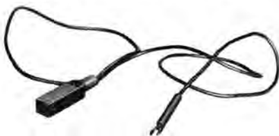
図 7.3 電圧測定用テストプラグ Fig. 7.3 Test plug for voltage measurement.
