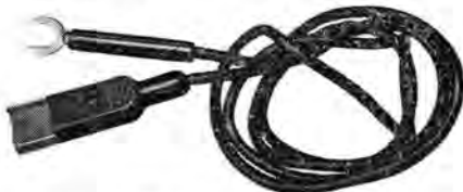
図 7.2 補助プラグ Fig. 7.2 Auxiliary test plug.
