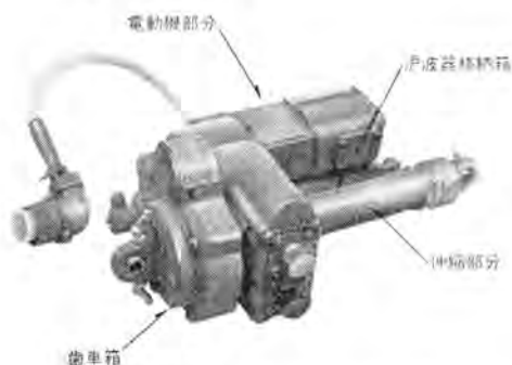
図 3.3 ウイングフラップアクチュエータ Fig. 3.3 Wing flap actuator.
