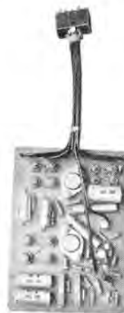
図 3.8 制御回路内部 Fig. 3.8 Interior view of the control circuit.
