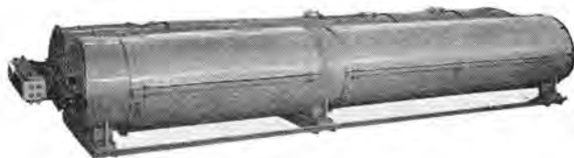
11 kV 6,000 A アルミ導体の離相母線温度上昇試験
