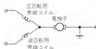
図 4.1 分割界磁形直流直巻電動機の結線図 Fig. 4.1 Connection diagram of split field type DC series motor.
