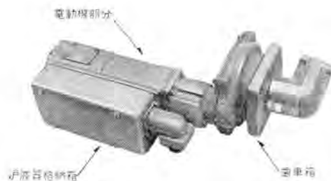
図 3.2 F-86 F 用キャノピアクチュエータ Fig. 3.2 Canopy actuator for F-86 F.
