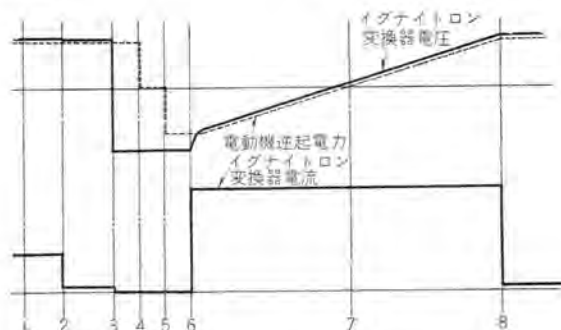
図 2.4 静止レオナード運転シーケンス Fig. 2.4 Static Ward-Leonard operation sequence.
