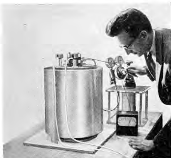
図 5.5 W 社における高温電池の実験
