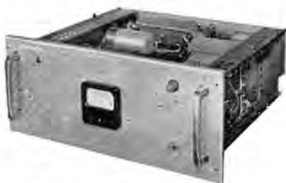
図 2.16 サーボ用 (400 c/s) 電源盤 Fig. 2.16 Appearance of the 400 c/s square wave generator panel.
