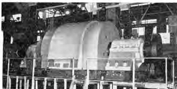
図 2.2 工場試験中の 18,000 kW 誘導電動機 Fig. 2.2 18,000 kW induction motor under factory test.
