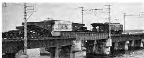
図 5.1 シキ-400B 1 形大物車による 260 MVA 主変圧器の輸送姿 Fig. 5.1 Transportation of 260 MVA transformer body.
