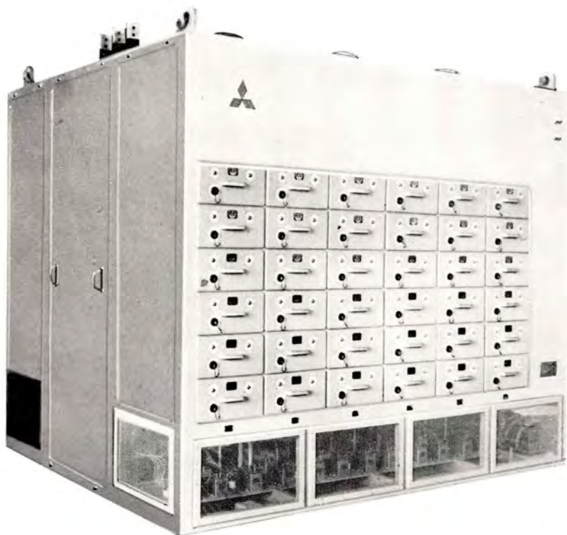
シリコン整流器 ▶ 容量 3,000 kW 直流電圧 1,500 V 直流電流 2,000 A 超重負荷公称定格
