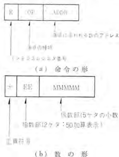
図 3.3 インターコム1000の命令と数の形 Fig. 3.3 Command form and number structure for INTERCOM-1000.
