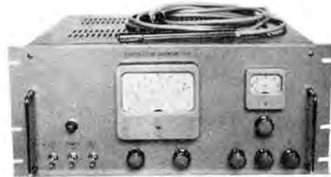
図 39. 自動温度補償形サーミスタ風速計
