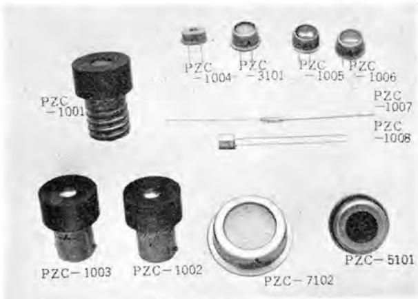
図 69. 光導電セル
