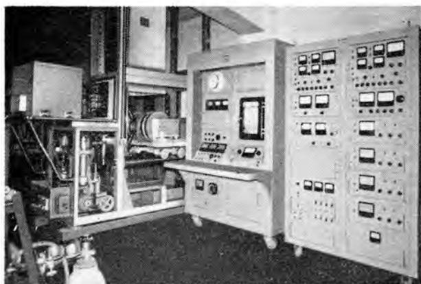
図 45. 超高真空用質量分析計 (MS-415 形)
