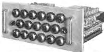
図 51. 時分割による直線補間を行なった関数発生器
