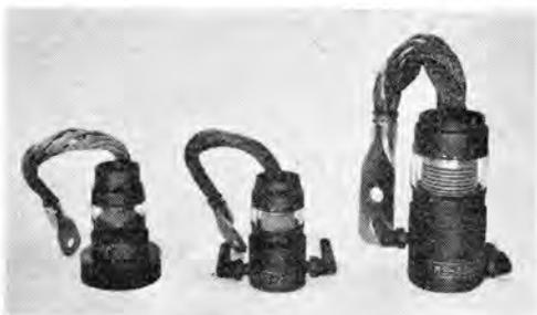
図 62. ゲルマニウム 電力用整流素子
