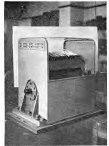
図 54. MELCOM-LD1 に用いられた遅延線形磁気ドラム
