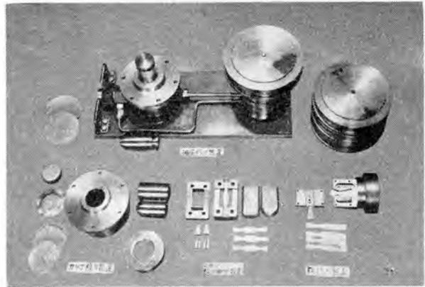
図 85. クサビ絞り試験および油圧絞り装置
