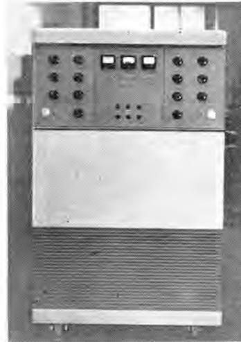
図 53. 昭和 32 年度通産省補助金による磁気円筒記憶装置
