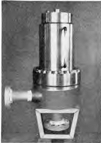
図 24. 15kW キャンド・モータ・ポンプ試作1号機
