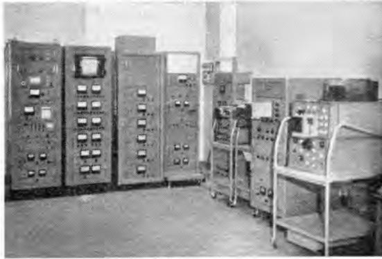
図 3. コロナ測定装置と衝撃電圧測定装置
