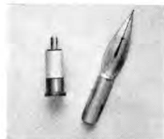
図 67. パラメトリック増幅器用シリコン可変容量ダイオード
