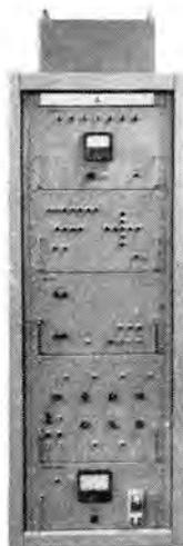
図 58. OPCON 方式による Schering bridge.
