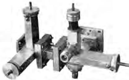
けた窓によって行なう。窓の位置はアイドラ電界の強い場所を選ぶが、ポンプ電力も漏れるから窓の先に $f_2$ のB.P.F.をつける必要がある。
