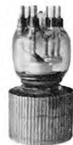
図 74. 強制風冷送信管 (7T36R)
