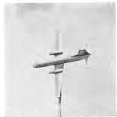
図 2.4 中形輸送機 YS-11 用 VHF 無指向性埋込み形アンテナ放射指向特性の 1/20 縮尺模型による測定
