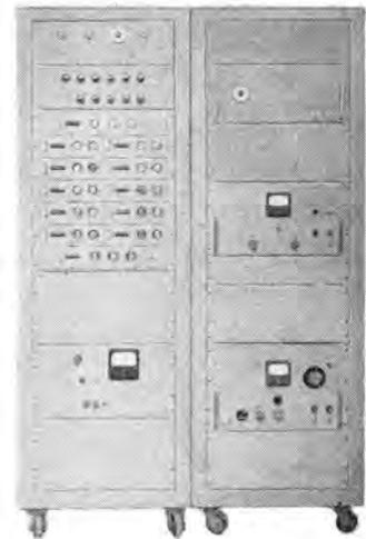
図 21. 飛行時間法中性子エネルギー分析装置. 右側が Time to pulse height converter, 左側が10チャンネルパルス波高分析器. (昭和33年8月阪大工学部納入)
