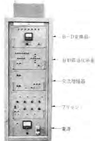
図 4.3 自動最適化装置を用いたインピーダンス・ブリッジの自動調整
