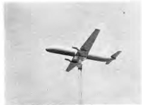
図 15. 国産中形輸送機 YS-11 の VHF 通信用テールキャップ・アンテナおよびブレード・アンテナならびに VOR 用空洞アンテナの放射指向特性の測定
