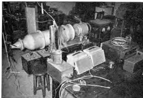
図 38. 風速計校正設備
