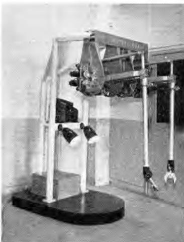
図 26. MA-E2 形 電気式 マスタ・スレイブ・マニプレータ
