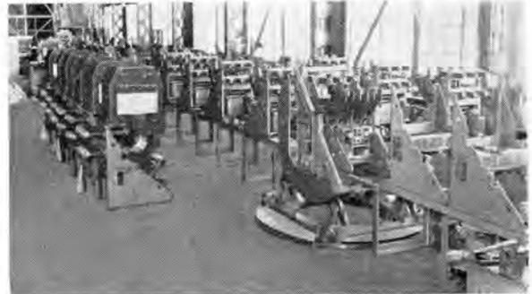
図4.1 シ断器フレームがレールの上を移動し組立工具により組立てられて行く状況
