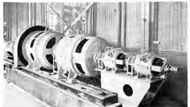
図 3.1 水力 50 kVA 電動発電機
