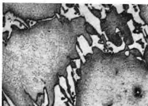
図 4.10 Ni-Cr-Si 合金の顕微鏡組織 (Ni 73.6%, Cr 15.2%, Si 8.1%) 5% 硫酸電解エッチ ×250
