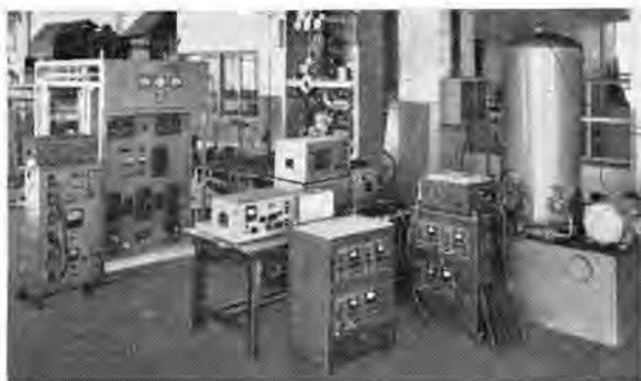
図 5.7 工場試験中の調速機
