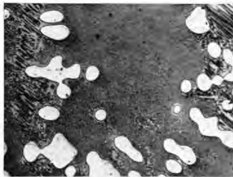
図 4.18 Ni-P 合金の顕微鏡組織 (Ni 93%, P 7%)
