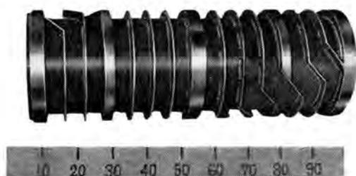
図 III. 2. 9 横軸カッタ用電動機冷却水通路
