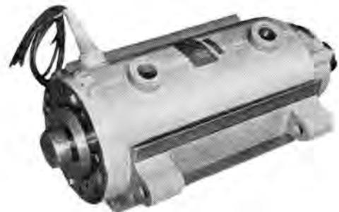
図 III. 2.7 立軸カッタ用電動機ブレーキ座
