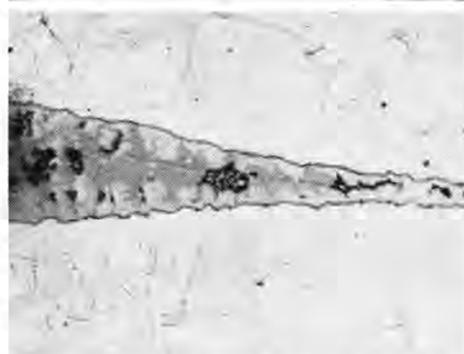
図 4.20 カニゼンメッキした 18-8 ステンレス鋼管のろう付断面の顕微鏡組織 10% 修酸電解エッチ ×100
