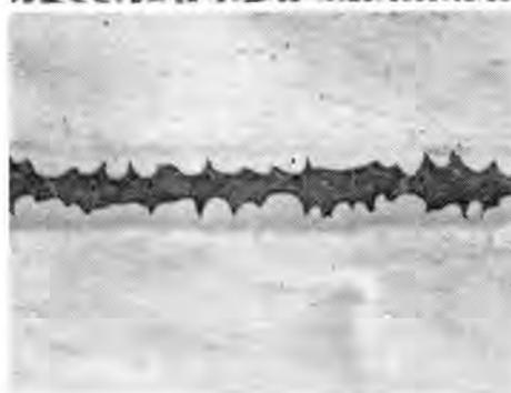
図 4.16 ろう付断面の顕微鏡組織 (Ni-Mn-Si 合金) 1,150°C 30分 10% 修酸電解エッチ ×100
