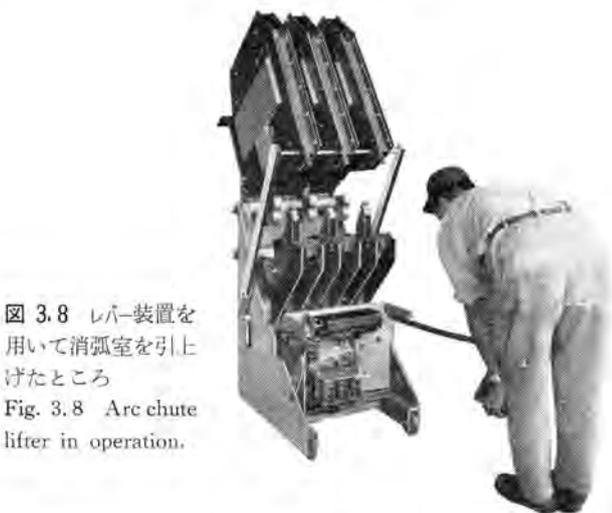
図 3.8 レバー装置を用いて消弧室を引上げたところ
