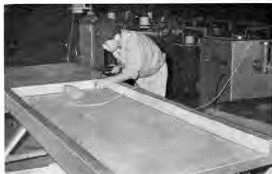
図 6.4 ボラールカーテン・ハウジングのもれ試験（スニフ法） Fig. 6.4 Helium leak test of boral curtain housing. (by Sniffer Method)
