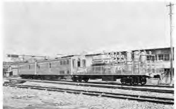
図 2.1 3,000 kW 1,500 V 液冷式 イグナイトロン整流器 移動変電所全景
