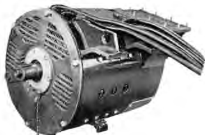
図 5.1 大形電気機関車用 WN ドライブ 525 kW 電車電動機 Fig. 5.1 WN drive 525 kW traction motor for large electric locomotive.
