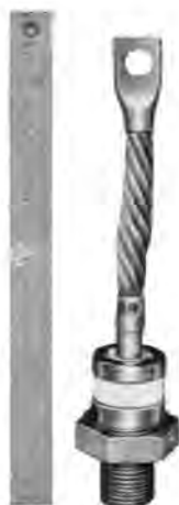
図 2.1 SR 200 F-20 シリコン整流素子 Fig. 2.1 Silicon rectifying element SR 200 F-20.
