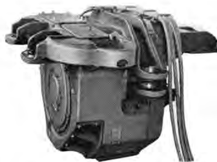
図 6.3 狭軌大形電気機関車用 600 kW 電車電動機 Fig. 6.3 600 kW traction motor for large electric locomotive of narrow gauge.
