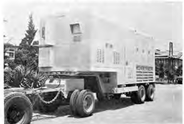
図 2.2 3,000 kW 1,500 V 風冷式 イグナイトロン整流器 トレーラ 牽引式整流器車
