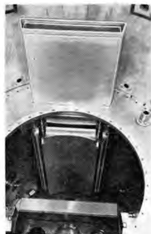
図 2.5 ボラルカーテンと鉛シャッタ Fig. 2.5 Boral curtain and lead shutter.
