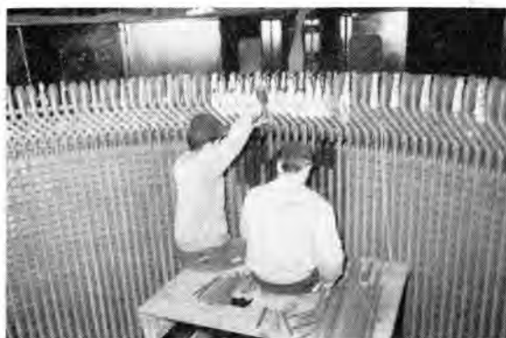
図 3.5 固定子コイル Fig. 3.5 Stator coils.
