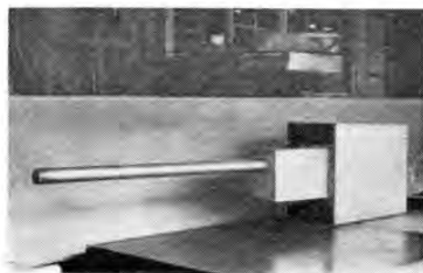
図 2.8 2B 気送管プラグ Fig. 2.8 2B Pneumatic tube plug.
