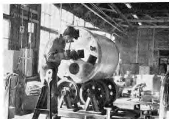
図 3.2 ロータリプラグ仕上作業 Fig. 3.2 Finishing work of rotary plug.
