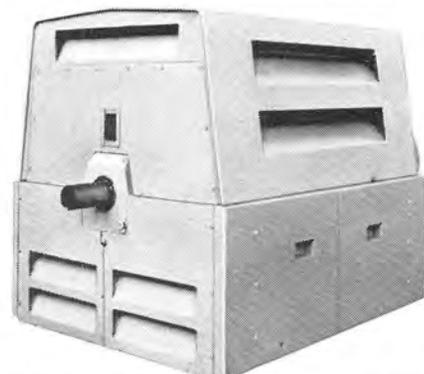
FA形 900 kW 3,300 V 4 P 60 c/s 三相誘導電動機
