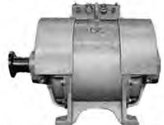
図 1-24 三菱造船納め 90kVA 自動交流発電機 90 kVA 三相 225 V 60 c/s 6 P 1,200 rpm 0.8 PF 90kVA Self-excited AC generator for Mitsubishi Ship Building Yard.
