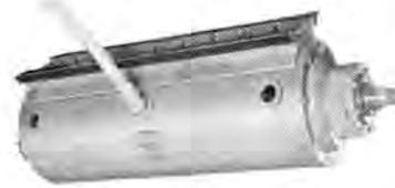
図 4-46 スーパーミラーカッタ用三相誘導電動機 MK 全閉水冷形 75kW 200V 50 c/s 2P 3,000 rpm
