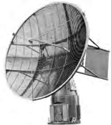
図 11-34 RC-3 形レーダ空中線装置
