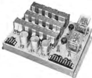
図 4-97 深穴ポール盤内ステップフィード装置
