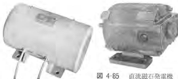
図 4-84 直流発電機 250 W
