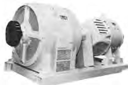
図 4-31 徳山曹達納めセメントキルンファン用電動機
