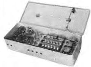
図 4-102 粗紡機用トランジスタリレー制御盤
