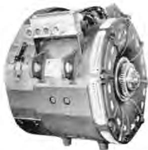
図 7-14 小田急電鉄 HE 車用 MB3039A 形主電動機 (1時間定格 120 kW 340 V 392 A 1,600 rpm)
