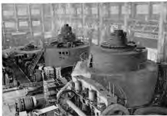
図 1-28 大物組立工場に並んだ水車発電機
