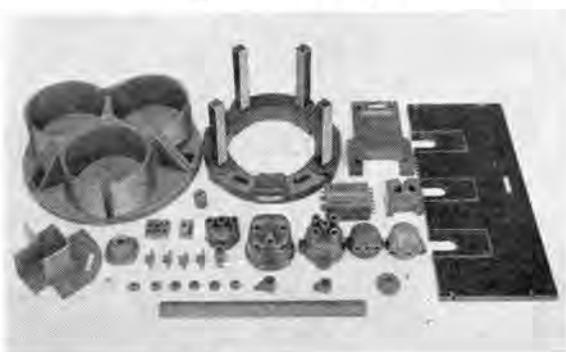
図 16-6 ダイヤミックス成型品
