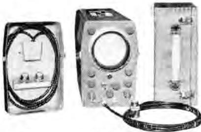
図 12-30 FD-5B 形超音波探傷機
