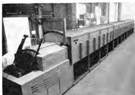
図 16-25 シュランクガラス用コベト電気炉
