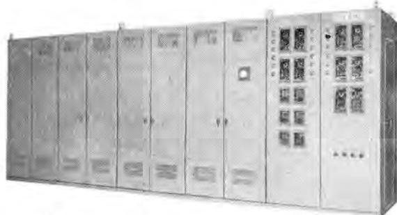
図 3-3 航空技術研究所納め遷音速風洞用 5,000 kW イグナイトロン整流器制御盤
