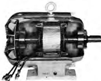
図 4-19 新 JEM 寸法 ダイアレン 防食電動機 2.2kW 8P 1521 フレーム 断面写真 Cutaway model of anticorrosive motor.
