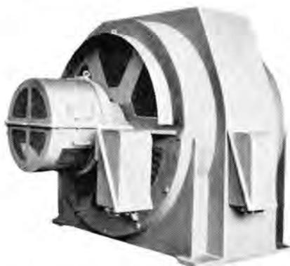
図 6-24 東亜港湾納め 1,100 kW 誘導電動機 3,300 V 60 c/s 360 rpm 閉鎖他力通風形
