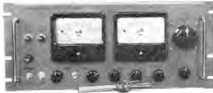
図 18-39 高圧電離真空計
