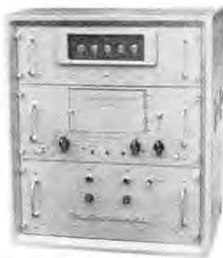
図 12-10 AD-201形デジタル電圧計
