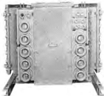
図 5-15 集団切羽開閉器 (側面) (台車積載形)
