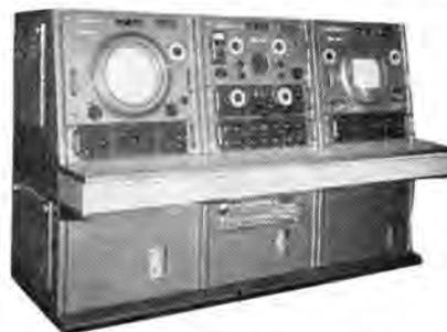
図 11-35 RC-3 形レーダ主指示装置
