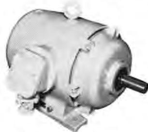
図 5-4 ホーベル用 耐圧防爆 三相誘導電動機 40 kW 4 P 400/440 V 50/60 c/s B 種絶縁。九検 3216 号 (H) 重量 480 kg。 Pressure-resisting explosion-proof three phase induction motor for use with hobels.
