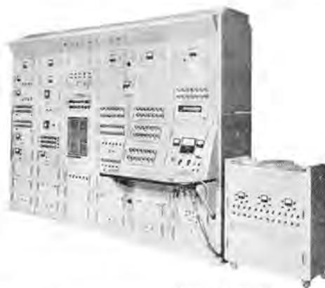
図 12-1 原子炉シミュレータ (MELCOM EA-7103形)
