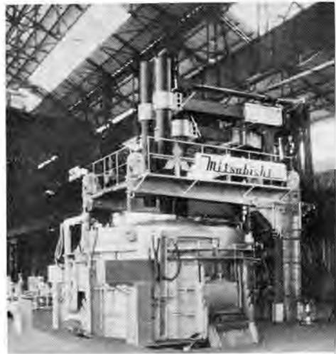
図 4-135 川口金属納め 20t アーク炉
