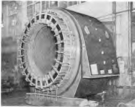
図 4-132 18,000 kW 電動機固定子
