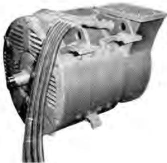
図 7-13 インド国鉄交流電関用 MB3045A 形主電動機 (連続定格 525 kW 725 V 780 A 1,020 rpm)
