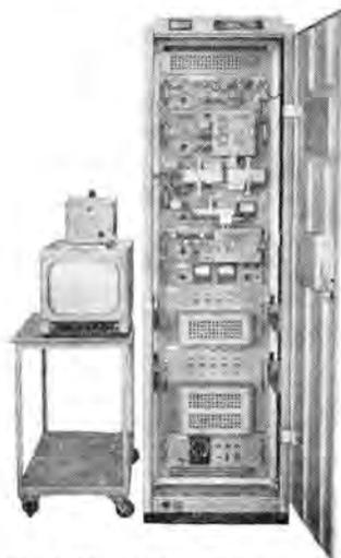
図 11-23 900 Mc 帯 ITV 無線伝送用送信機
