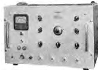
図 12-32 超音波減衰測定装置本体
