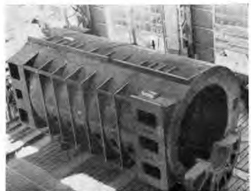
図 1-2 東京電力横浜発電所納め 224,000 kVA 内部冷却発電機フレーム
