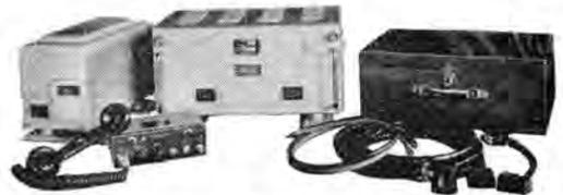
図 11-16 SM-1E 形移動用 26 Mc SSB 無線電話装置
