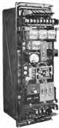
図 2-70 KLV-FT 形無電圧検出継電器
