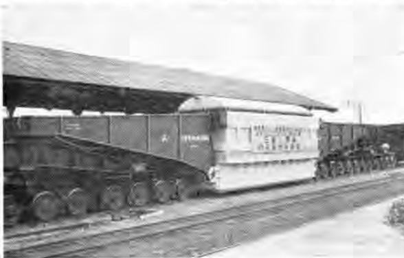
図 2-1 京浜変電所納め変圧器の輸送荷姿
