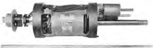
図 4-48 ユニバーサルドリリングマシン用電動機 MK 形 閉鎖通風形 ワク番号 50 S 1.1/0.9 kW 2/4 P 200 V 50/60 c/s 振動 V-10 級 定格 30/20 分 Universal drilling machine motor.
