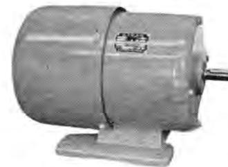
図 4-57 豊田工機納め直流電動機 750 W 160 V 6 A 4 P 300~3,000 rpm 連続 他励分巻 励磁電圧70 V 全閉外扇形 DC motor.
