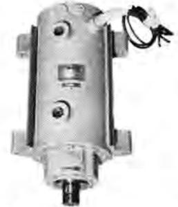
図 4-47 スーパーミラーカッタ用三相誘導電動機 MK 全閉立形水冷形 15/11/7.5 kW, 600/400/200 V, 150/100/50 c/s 2P 9,000/6,000 3,000 rpm
