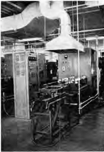
図 12-28 EH-1E 形 7 kW ラジオヒータ および温度制御装置
