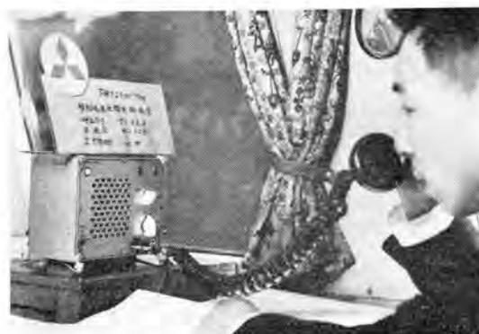
図 11-13 実験中の移動局 (400 Mc 帯)
