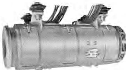
図 7-17 国鉄 EF30 形電用 MG-61A-S 形電動発電機
