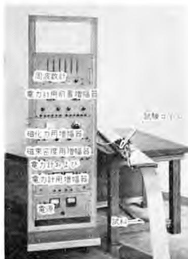
図 16-27 鋼帯の磁気特性自動記録装置用磁気測定部
