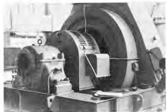
図 6-23 池畑組納め 1,500 W 誘導電動機 3,300 V 60 c/s 400 rpm 閉鎖他力通風形
