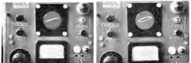
図 16-33 直径が小さい場合の外欠陥の図形をあらわす
