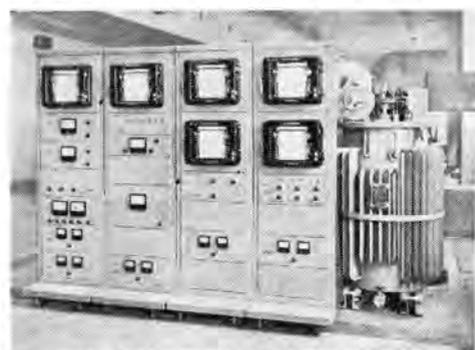
図 18-2 機能試験用各種記録装置
