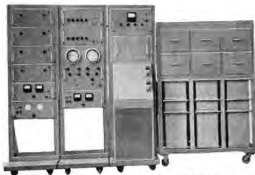
図 18-5 半導体整流器特性直視装置
