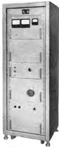
この方式で出力電圧最大 60 V、出力電流 5~150 A の範囲の各種励磁電源が作られており、従来真空管で行なわれていた中出力以上の安定励磁電源はすべてトランジスタ化することができる。従来の定電流回路と比較し、外形寸法で 1/3、価格で約 2/3 にすることができた。
