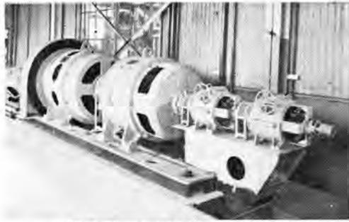
図 2-58 水力 50 kVA 端子電源
