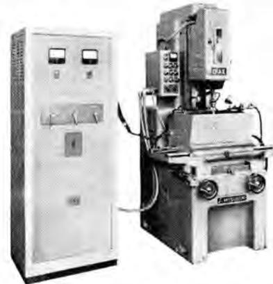
図 12-29 DM-101B 形三菱ダイアックス放電加工機
