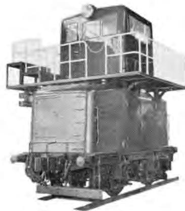
図 7-7 川崎製鉄千葉納め 20 t 消火車ケン引用機関車
