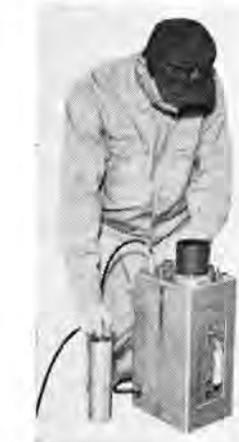
図 12-31 FD-6 形超音波探傷機
