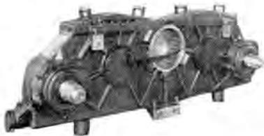
図 7-15 国鉄 EF30 電関用 QD6-2 形伝導歯車装置
