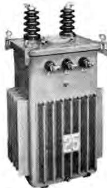
図 2-19 13.2 kV 単相 25 kVA 60 c/s 配電用変圧器
