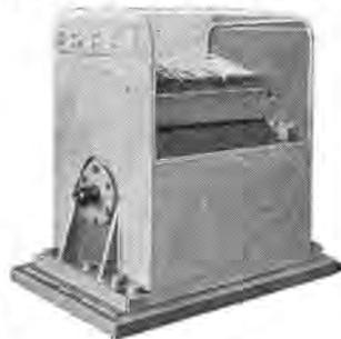
図 18-7 遅延線形磁気円筒記憶装置
