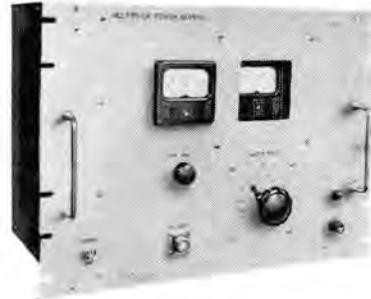
図 18-23 高真空質量分析計用電子増倍管用高圧安定化電源
