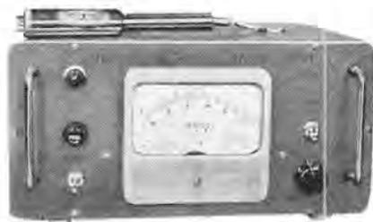
が振れ指示を与える。その特性は図 18-40 のようになる。この特性から明らかのように  $10^{-3} \sim 1$  mmHg の真空度の測定が可能であるが、サーミスタの熱容量、多孔性、抵抗特性の不ぞろいなどのために他の真空計に比べて誤差は大きく、10% 程度である。
