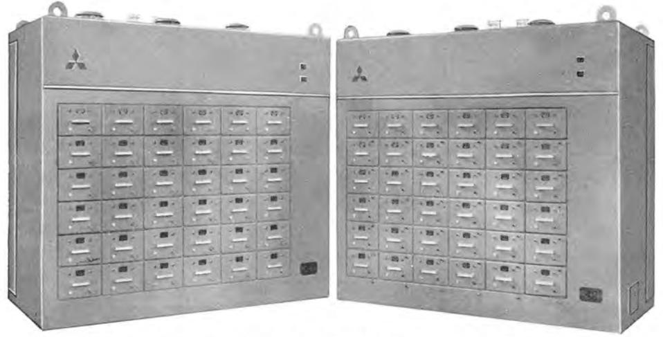
三菱金属鉱業秋田製錬所納め 亜鉛電解用シリコン整流器
