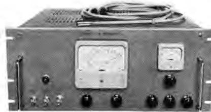
図 18-18 自動温度補償形サーミスタ風速計
