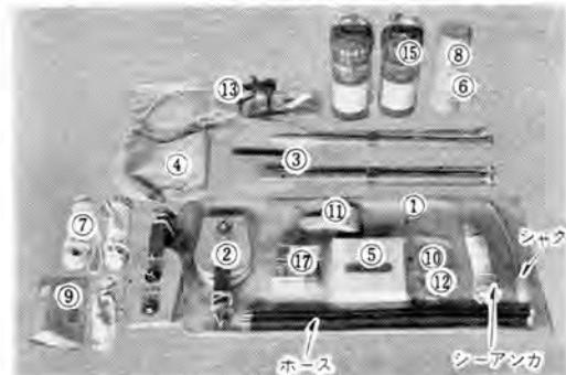
図 16-47 MTA-15 形救命いかだ付属品 Type MTA-15 life raft and accessories.
