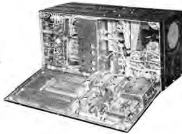
小形のものを使用している。また RF 増幅部、第 1 IF 増幅部、第 2 IF 増幅部、デスクリ部などを保守点検に便利なようにサブユニット構造とし、接センにより着脱可能にしてある。周波数切換えは、制御器の周波数切換えスイッチによって遠隔制御され、24.0~51.9 Mc の範囲内で、100 kc 間隔の 280 チャネル中の任意の 1 波を選択することができる。主要性能の概略は、つぎのとおりである。
