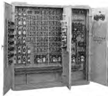
図 4-49 CDG 形コンディスク研削盤用制御盤
