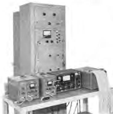
図 7-28 空気圧自動制御装置
