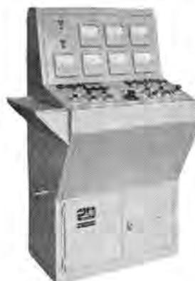
図 4-51 DSG-23 C 形両頭研削盤用操作盤
