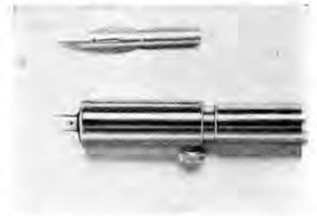
温サーミスタビードを組み込み後者の出力で測風エレメントの印加電流を制御させることによって自動的に気流の温度変化に対する補償を遂行させる形式のもので試作器の測定範囲は0~5、5~20、20~40 m/secの3段切換え、温度補償範囲は-3~60°Cにわたり温度指示の機能も兼ねている。
