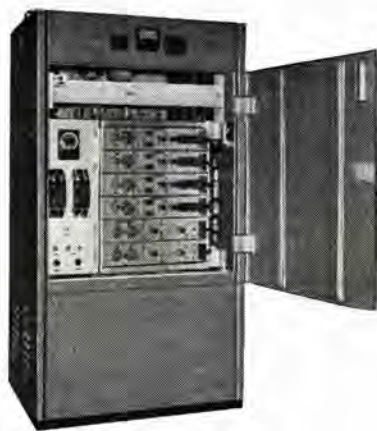
図 2.2 空中線制御装置の内部 Fig. 2.2 Interior of antenna control device.
