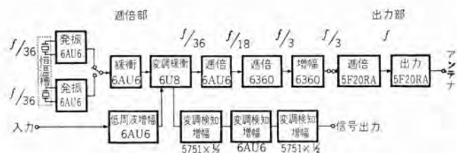
図 3.15 基地局送信部系統図
