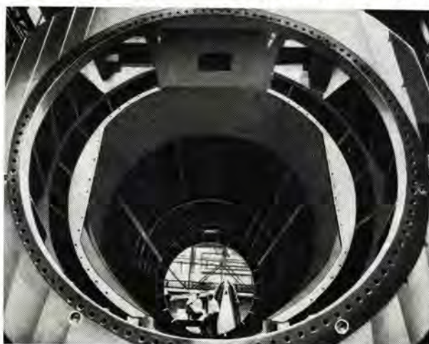
384 MVA タービン発電機の固定子フレーム
