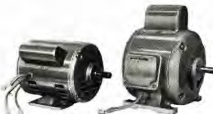
SC-RT 形と SC-AT 形の外形比較 左側 SC-RT 形 (新) 右側 SC-AT 形 (旧) おの 200 W 4 P 100 V 50/60 c/s
