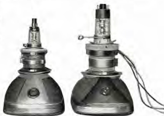
図 2.1 トランジスタチューナと真空管チューナ Fig. 2.1 Transistor tuner and vacuum tube tuner
