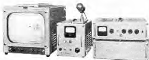
図 6.4 IT-4 形 ITV 左より監視機・電源装置・撮像制御機 (上) および同期信号発生部 (下)
