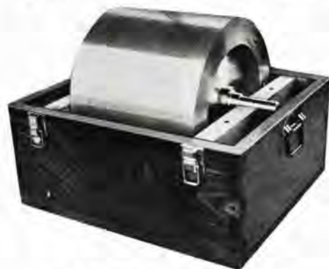
図 1.2 磁気ドラム A 形の回転体
