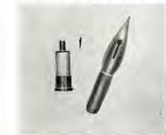
図 1.1 メーバ用可変容量シリコンダイオード Fig. 1.1 Silicon variable capacitor for parametric amplifiers use.
