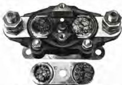
図 5.2 電動機負荷 50,000 回後の接点
