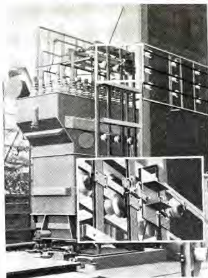
図 6.5 FL-13×600 形 ヒューズシャ断試 験状況
