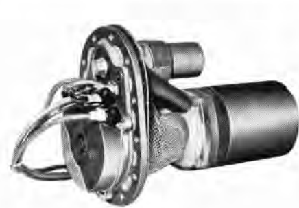
図 2.1 燃料ブースタポンプ 形式 MDK-TF 31400-3 Fig. 2.1 Fuel booster pump, type MDK-TF 31400-3.
