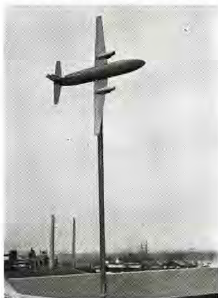
図 4.5 VHF テールキャップアンテナ 輻射指向特性の20分の1縮尺模型による測定
