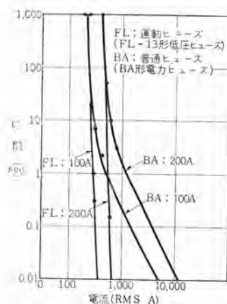
図 2.1 普通ヒューズと速動ヒューズとの溶断特性比較図 Fig. 2.1 Comparison of melting time-current characteristics with fast acting fuse and ordinary fuse.
