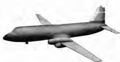
図 4.1 HF テールキャップアンテナインピーダンス特性および VHF テールキャップアンテナ 輻射指向特性測定用中形輸送機 YS-11 20 分の 1 縮尺模型
