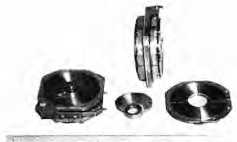
図 4.4 三角関数 コンピューティングコンデンサ Fig. 4.4 Trigonometrical function computing condenser.
