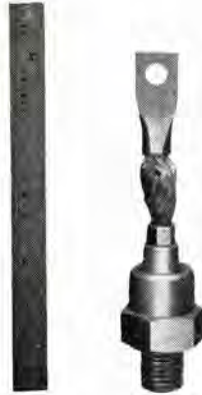
図 7.2 シリコン整流素子 (SR-107) Fig. 7.2 Silicon diode.
