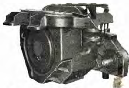
図 6.6 伝導歯車装置をとりつけた主電動機 Fig. 6.6 Traction motor equipped with a transmission gear unit.
