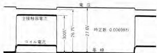
図 5.4 カットアウトリレー AN 3025-300 常気圧における誘導負荷試験 Fig. 5.4 Inductive load test of AN 3025-300 cutout relay at normal atmospheric pressure.
