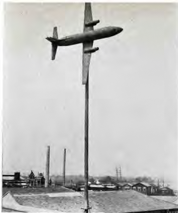
図 V.2.4 VHF テールキャップアンテナ 輻射指向特性測定中の中形輸送機 20 分の 1 縮尺模型
