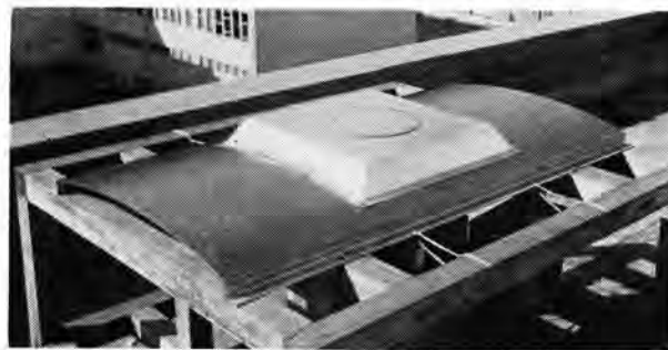
(b) 列車無線用として開発した環状スロットアンテナ
