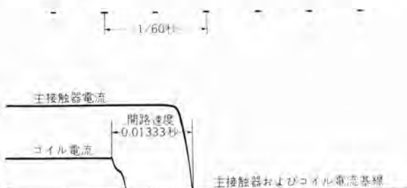
図 5.7 カットアウトリレー AN 3025-300 主接触器開路速度 Fig. 5.7 Main contactor opening speed of AN 3025-300 cutout relay.
