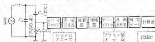
図 3.1 コナ測定回路
