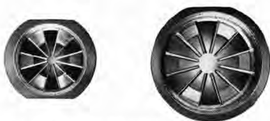
図 2.1 MX-702, MX-502 に使用した Rising sun 形陽極 Fig. 2.1 Rising sun anodes for MX-702 & MX-502 magnetrons.
