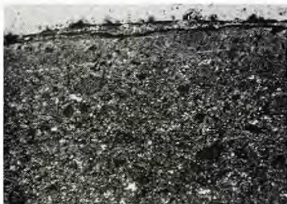
図 3.37 ⊖ side, 200 A, Normal の断面組織 (×120)
