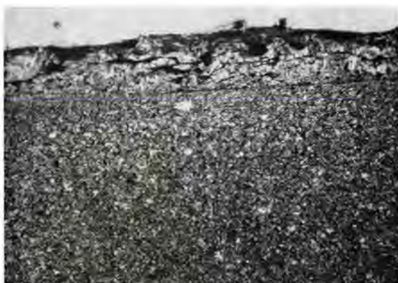
図 3.36 ⊖ side, 200 A, Normal の断面組織 (×120)
