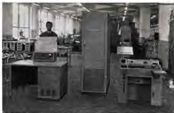
自動翻訳機 (左から制御装置、演算装置とドラム記憶装置、入出力装置)
