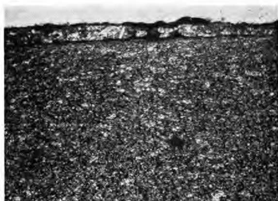
図 3.33 ⊖ side, 400 A, Breaking の断面組織 (×120)
