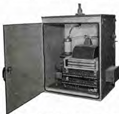
図 3.2 PBA-3A 形 コンデンサブッシング PD の内部
