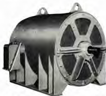
図 3.4 耐圧防爆形冷却管付全閉外扇形誘導電動機 150 kW 3,300 V 60 c/s 12 P エアコンプレッサ用 Fig. 3.4 150 kW pressure-resistant explosionproof fan cooled with cooling pipe induction motor.
