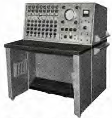
図 3.1 MELCOM 繰返形 アナログコンピュータ (EA-100 形) Fig. 3.1 Appearance of a MELCOM repetition type analog computer. (Type EA-100)
