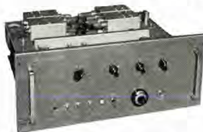
図 2.14 正弦波発生器の外観
