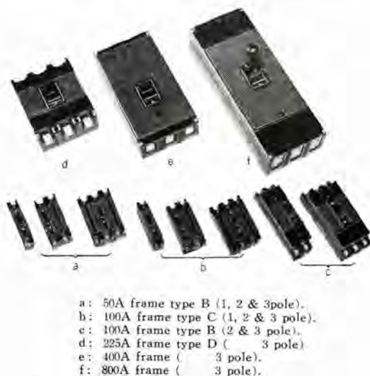
図 1.1 新形、NF 形 ノーヒューズシャ断器の外観 Fig. 1.1 Front view of new no-fuse breakers.
