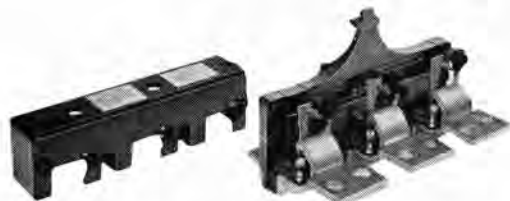
図 2.19 800 A フレーム、三極、ノーヒューズシ断器の引はずし装置 (熱動一可調整電磁形、取換形)
