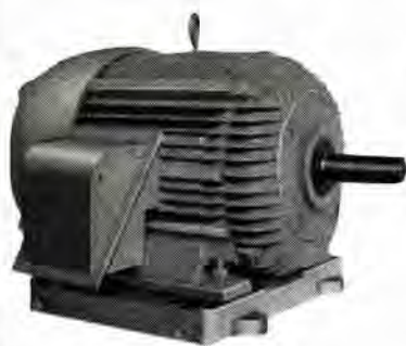
図 3.1 全閉外扇形誘導電動機 15 kW 200 V 50 c/s 6 P ワッ 番 2031 ポンプ用 Fig. 3.1 15 kW totally enclosed fan cooled induction motor.
