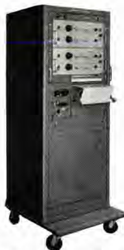
図 3.1 サンボーン熱ペン書オシロ記録装置外観 Fig. 3.1 Appearance of SANBORN heated stylus type oscillograph.
