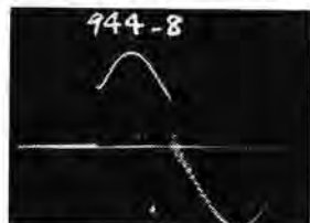
図 7.1 FL 形ヒューズで短絡電流をシタ断したときのヒューズ電圧オシロ
