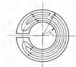
図 4.11 中空円筒断面で円周上に切れ目がある場合 Fig. 4.11 Case of having a gap on a circumference of hollow cylindrical cross section.
