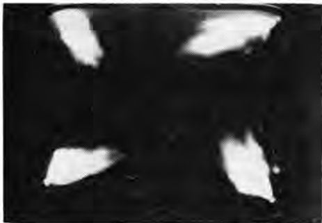
図 3.10 中国電力小野田火力発電所における炉内燃焼状況監視受像画面 重油バーナ点火時
