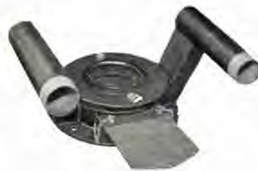
図 3.9 関西電力大阪発電所における炉内燃焼状況監視用のぞき窓
