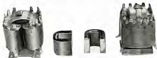
机上電子機器用 400 c/s 80 VA 電源 トランス 400 c/s 80 VA transformer of source
