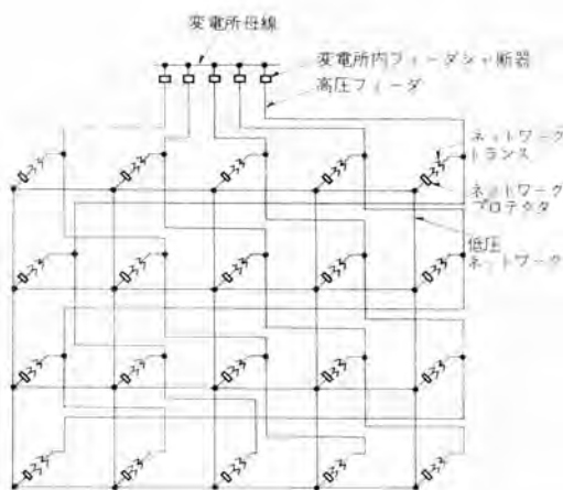
ネットワークプロテクタ 使用例図 Schematic diagram of network system.
