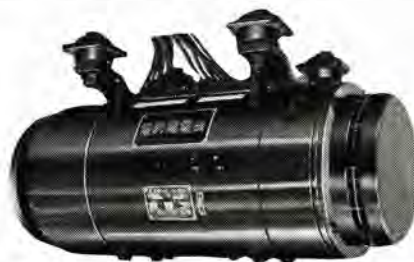
阪神電鉄 JET car 用 MG62S 形電動発電機 定格 電動機直流 6.3 kW (入力) 600 V 2 P 発電機交流 3.5 kVA 110 V 3 φ 60 c/s 四線式 2 P 3,600 rpm 重量 370 kg Type MG62S motor generator.
