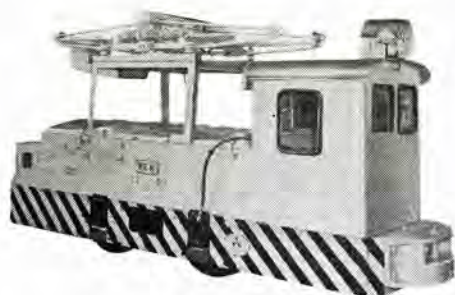
三菱鉱業納め 8t 鉱山用電気機関車 8t mine electric locomotive for Mitsubishi Kogyo.
