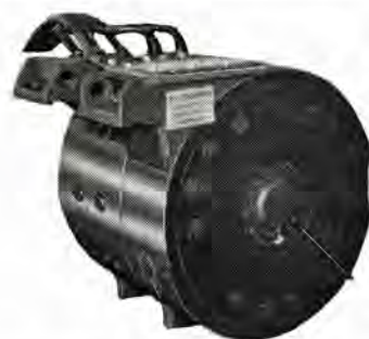
国鉄 ED71 交流電機用 MT101 形主電動機 （連続定格 475 kW 660 V 775 A 1,140 rpm） Type MT101 traction motor for J.N.R. ED71 AC electric locomotive.
