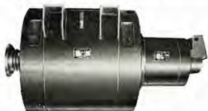
国鉄向け簡易交流電車主電動機用 MK EV 形単相誘導電動機 134 kW 400 V 50 c/s 4 P 1,500 rpm 770 S フレーム 連続定格 H 種絶縁起動電動機および遠心力スイッチ付 起動電動機 7.5 kW 400 V 50 c/s 4 P 1,500 rpm 30 分定格 A 種絶縁 コンデンサ 起動形 コンデンサ 350 μF 1,000 W.V. Type MK EV single phase induction motor for J.N.R. simplified AC electric car traction motor.
