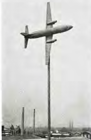
VHF 帯 テールキャップアンテナ 輻射指向特性測定中の国産 中形輸送機 YS-11 1/20 縮 尺模型
