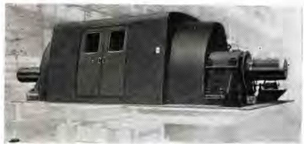
遷音速風洞用 4,500 kW 直流電動機 4,500 kW DC motor.
