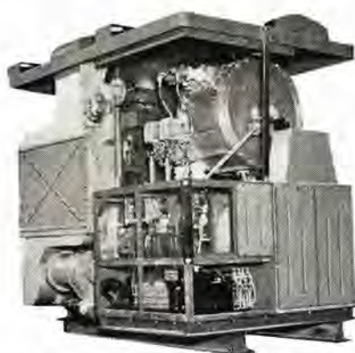
交流電気機関車用負荷時 タップ 切換器 On-load tap changer for AC locomotive.
