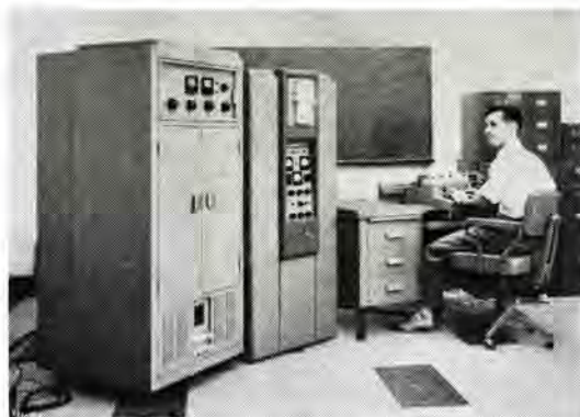
デジタル演算高速化装置をプログラムにより試験中の G-15D 電子計算機
