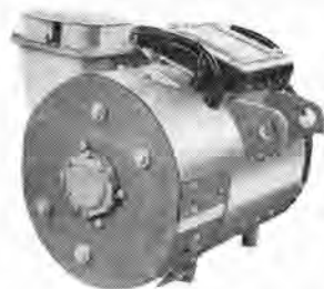
京成電鉄向け MB3028E 形主電動機 （1 時間定格 75 kW 375 V 225 A 1,650 rpm） Type MB3028E trac- tion motor for Keisei Railway.
