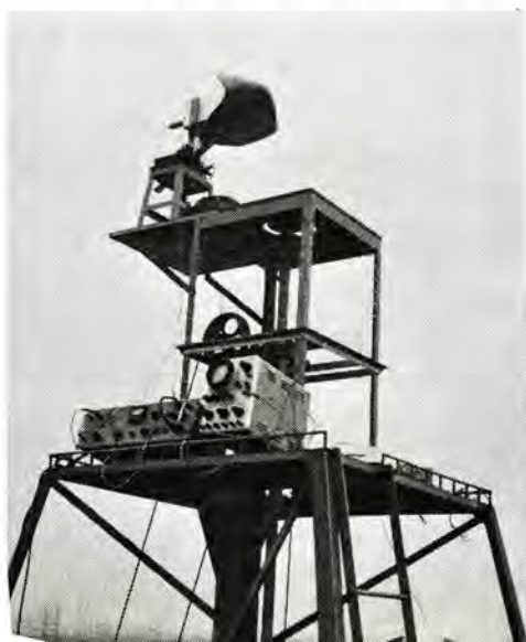
電力透過率測定中の ジェット機用ラドーム The radome for jet airplane under the measurment of power transmission coefficient.
