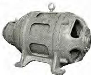
インド向け輸出交流電気機関車用 MKO 形相変換機 150 kVA 400 V 50 c/s 4 P 1,500 rpm 780 フレーム 連続定格 H 種絶縁 入力側 単相交流 400 V 50 c/s 450 A 出力側 三相交流 400 V 50 c/s 215 A 4 kW 直流発電機直結 Type MKO phase converter for AC electric locomotive for export to I.N.R.
