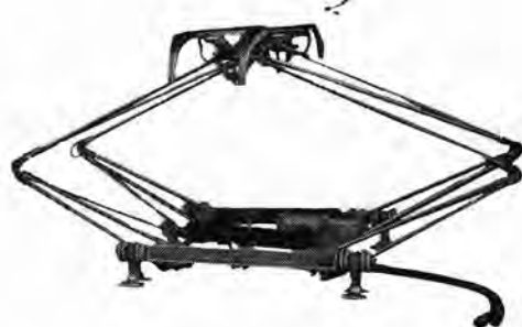
S752A 形 パンタグラフ Type S752A pantograph.
