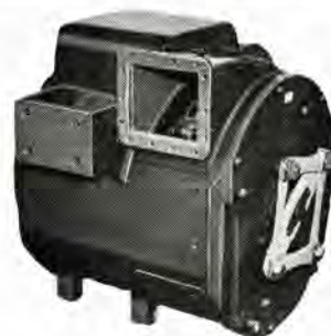
国鉄単相 60 サイクル 交流 専用電車用 MB5001A 形 整流子電動機 （1 時間定格 150 kW 200 V 1,030 A 2,280 rpm） Type MB5001A single phase 60 c/s AC com- mutator motor for J.N.R. AC electric coach.
