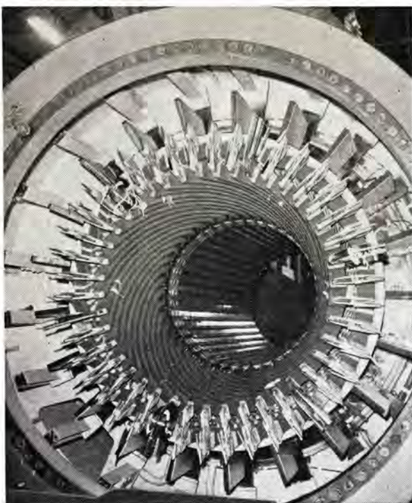
208,696 kVA タービン 発電機固定子 (通風用 ベントチューブが見えるがテーパでふさいである)
