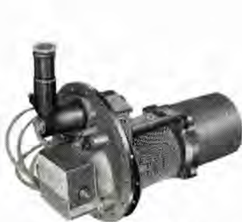
T-33A 用燃料 プースタポンプ MDK-TF29600-2 27 VDC 6,000 lb/h 14~25 psi
