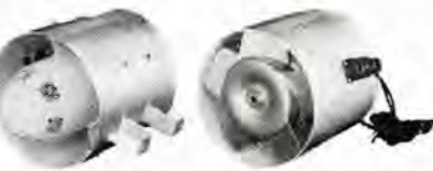
電動送風機 風量 15 m 3 /min 風圧 45 mmAq 24 V 5,000 rpm 2 P 連続 Motor fan air volume 15 m 3 /min air pressure 45 mmAq.
