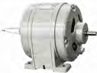
誘導器 200 VA 200/ 200 V 単相 50/60 c/s 2 P 連続定格 Inductor.
