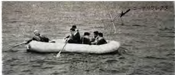
大形航空機搭載用救命浮舟 (6 人用) Life boat carried on air plane.
