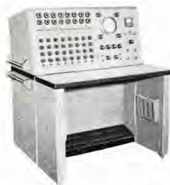
EA-100 形繰返形 アナログコンピュータ Type EA-100 repetitive analog computer.
