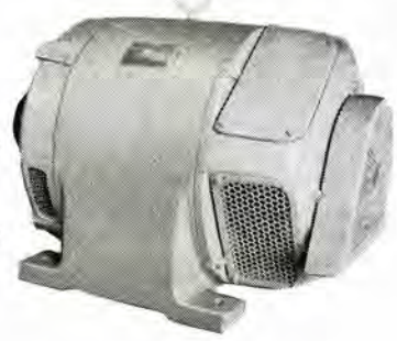
九州地方建設局納め 自動交流発電機 30 kVA 220V 三相 60 c/s 1,200 rpm 6P 0.8 PF 連続定格 30 kVA self excited AC generator for Kyushu Local Construction Bureau.
