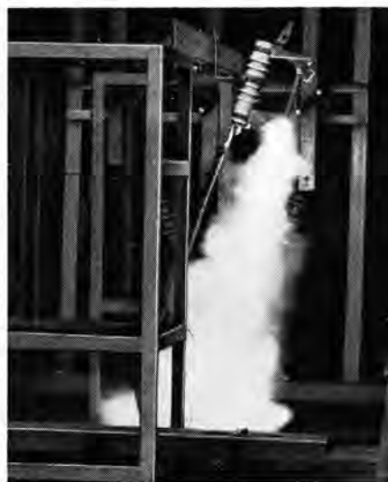
受注に先立ち当所大電力 シュ断試験場で シュ断試験中の DXM-1 形 6,900 V ヒューズカットアウト
