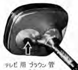
コパーロイ-100 (KV-100) で作られたアノードボタン Anode button made of kovalloy-100.
