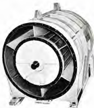
四国電力野村発電所納め 660 kW 誘導発電機 (水車側) 6,600 V 60 c/s 720 rpm 10 P 660 kW induction generator for Shikoku Electric Power Co.
