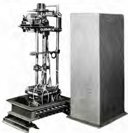
高感度赤外線ガス分析計 High sensitive infrared gas analyzer.
