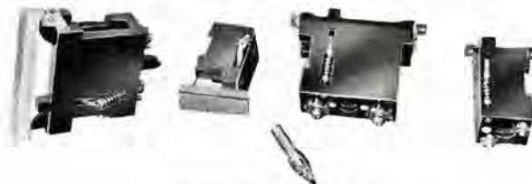
照光単位体とそのソケット Unit and socket of illuminating mimic bus.
