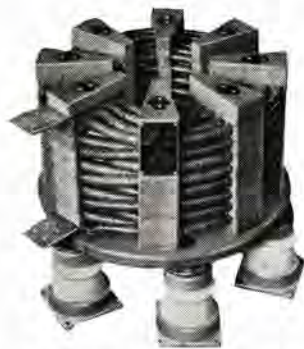
東洋曹達納め CL 形リアクトル 単相 60 c/s リアクトランス 3% 連続定格 回路電圧 3,300 V 定格電流 500 A CL Type reactor.
