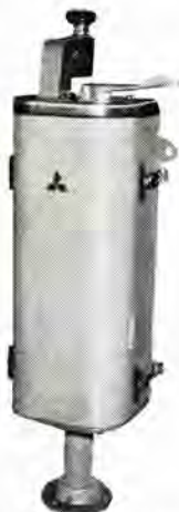
近鉄新形ビスタ・カー用 KL120形主幹制御器 Type KL120 master controller for Vista car.
