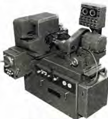
全自動心なし内面研削盤 Automatic internal grinder.
