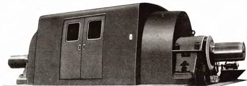
工場試験を完了した 4,500 kW 直流電動機。（中央に新しい構造の両開き戸が設けてある）
