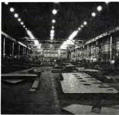
⑱ 三菱造船長崎造船所（長崎）溶接工場 HF-400 光源高さ 27m。
