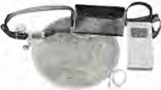
「V-1 形」受令機 1 式 (共鳴管、トップネットアンテナ、皮ケース、本体) Type V-1 30 Mc/FM receiver (complete) (acoustic resonator, topnet antenna, carrying case and receiver).
