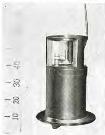
汚水処理ポンプ用水封式水中形三相誘導電動機 0.4kW 200V 50/60 c/s 1,500/1,800rpm 4P Watersealed type underwater motor for sewage use.
