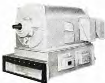
ターボ冷凍機用誘導電動機 (全閉内気循環形、空気冷却器付) GB 巻線形 260 kW 3,300 V 60 c/s 2 P
