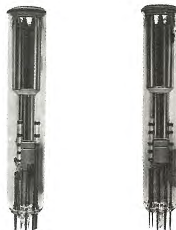
図 1.1 試作ビジコンの外観 左 6198A, 右 6198
