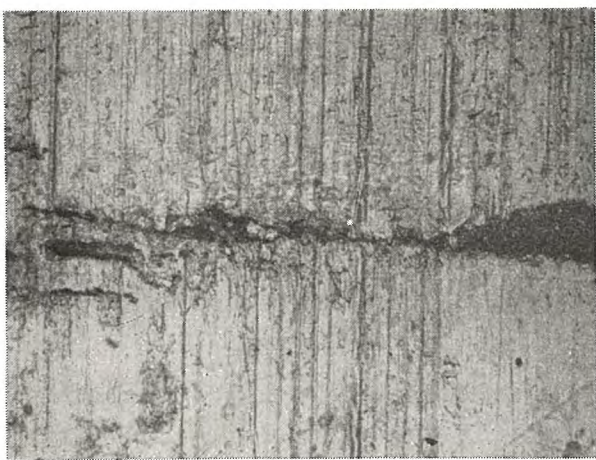
図 3.20 ノッチ性介在物（裂開形介在物）
