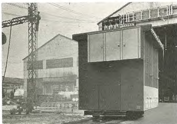
図 4.1 注水試験中のキュービクル Fig. 4.1 Cubicle under rain test.
