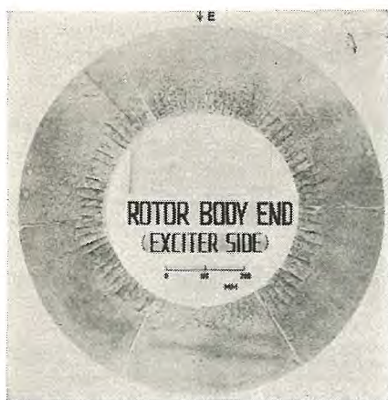
図 3.4 真空鑄造軸材の胴端面サルファプリント Fig. 3.4 Sulphur print from body end surface in A-forging.
