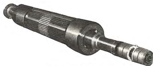
図 6.3 完成した回転子 Fig. 6.3 Completed rotor.
