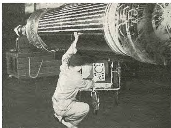
図 3.22 半月形ミゾによる特殊超音波探傷
