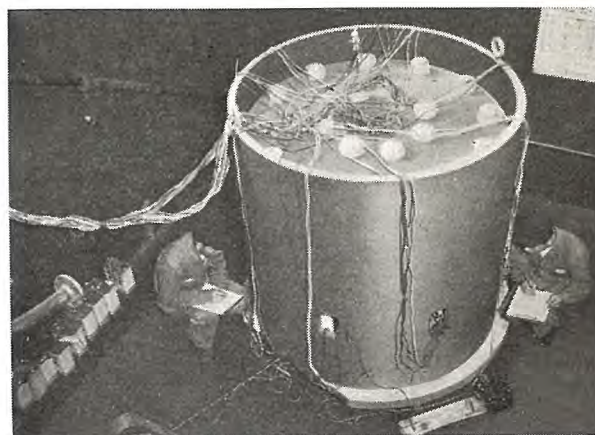
図 6.4 コイル押えリングの油圧試験 Fig. 6.4 Oil pressure test of coil retaining ring.
