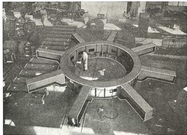
図 4.20 上部ブラケット Fig. 4.20 Upper bracket.
