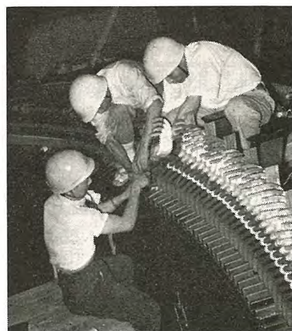
図 III, 2.3 固定子巻線 (コイル入れ) Fig. III. 2.3 Inserting stator coils into slots.
