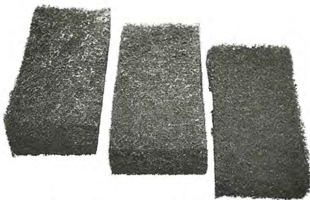
図 2.1 獣毛ヘアーロック形電波吸収壁材の外観 Fig. 2.1 Microwave absorber of rubber-impregnated animal hair.
