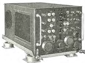
図 1.2 APG-30A レーダ装置に取付けた CA 形防振足 Fig. 1.2 Vibration isolator, type CA, installed in APG-30A radar set.
