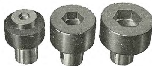
電極 黄銅 3/8"; 3/4"; 1" 用(電極本数 2 本) 被加工物材料 ダイイス鋼 加工時間 3/8" で 1 時間
