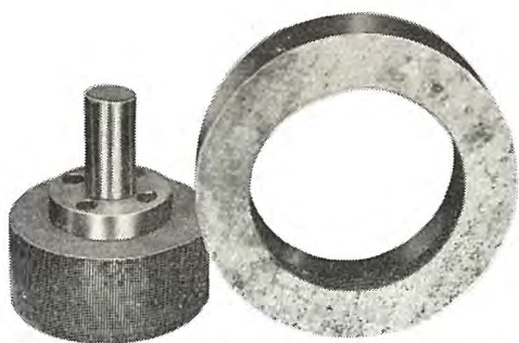
電 極 黄銅および鋼 (仕上用)それぞれ 1 本 外形 80φ 被加工物 焼入鋼 加工厚 9 mm 加工時間 4 時間
