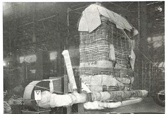
図 5.5 誘導加熱によるタンク加熱と熱風乾燥機使用により乾燥中の 312,000 kVA 変圧器 1 相 Fig. 5.5 312,000 kVA transformer in drying combined with the induction heating of tank wall and hot air blast by induction heating.
