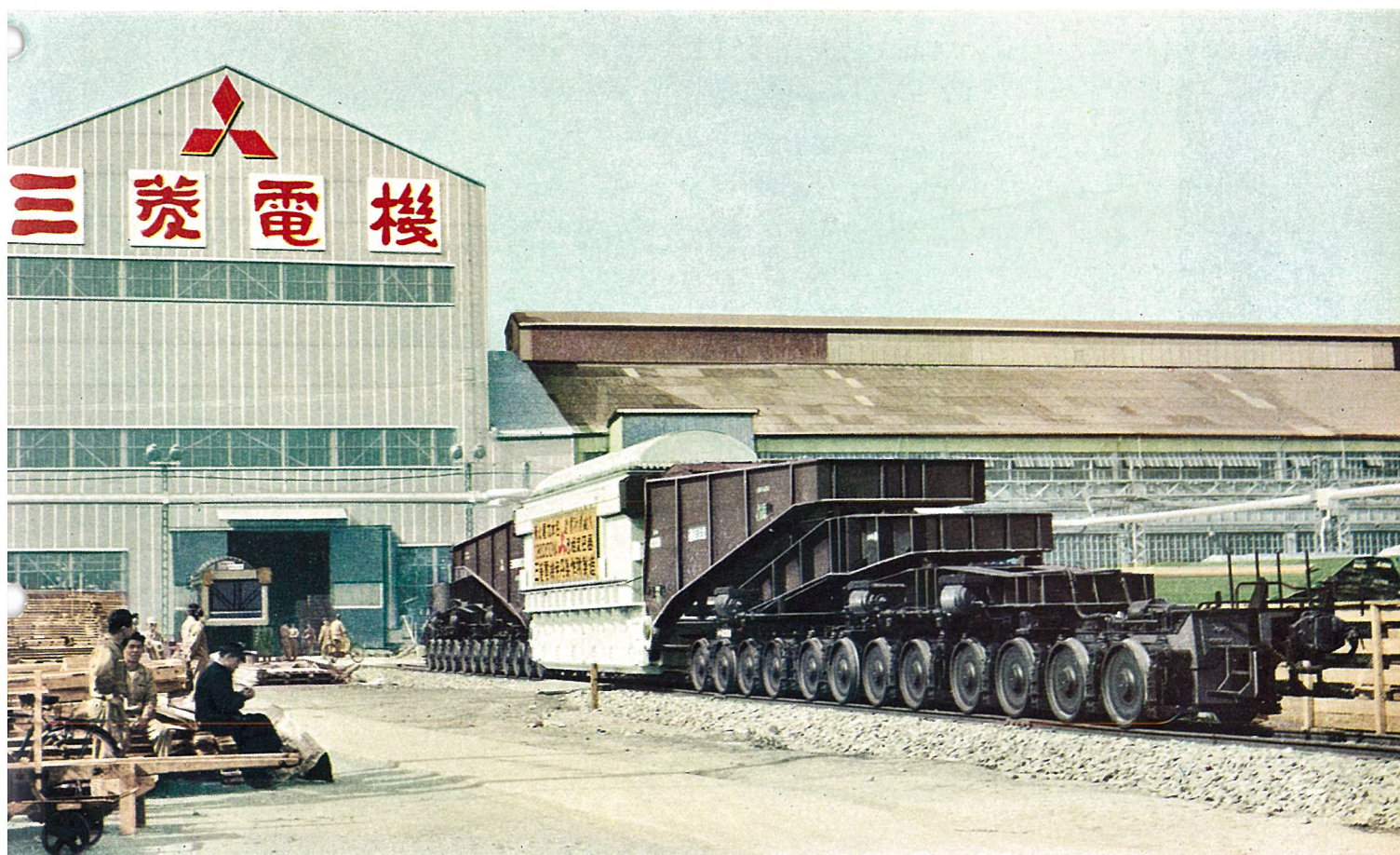
わが国最大のシキ 400 形大物貨車による本名向け変圧器の輸送
