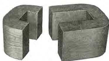
図 3.8 ケーブル挿入 分割形変流器 80.5 kV OF ケーブル用 1,000-800-600/5A 40VA 1.0 級 ダイヤレジン含浸形 Fig. 3.8 Split type current transformer applicable to cable.
