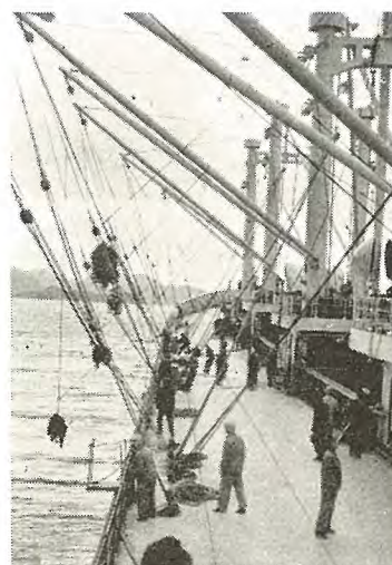
図 2.10 荷役試験中の WORLD JASMINE 号 Fig. 2.10 S. S. WORLD JASMINE during loading cargo test
